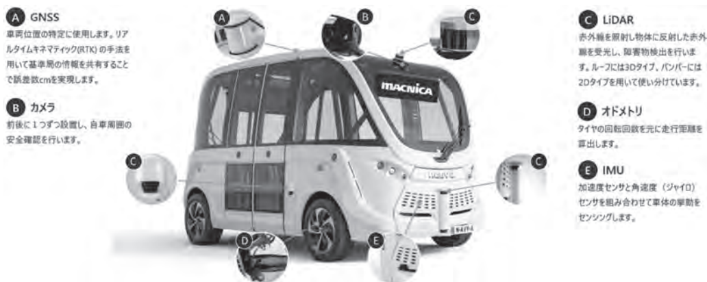
図一2 自動運転シャトルバスのセンサー構成
