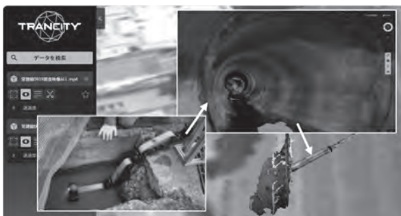
図一13 ヘビ型ロボットによる管内および管路ルートの3次元化
