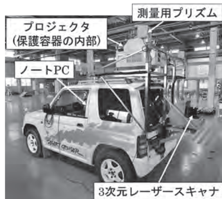
図-3 切羽版 SP-MAPS の機器構成
