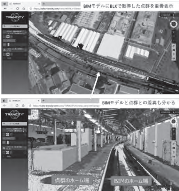
図一八 レーザースキャナで取得した点群の活用
