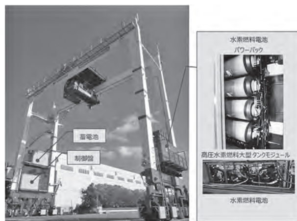
写真-1 ラバータイヤ式門型クレーンとFCPP
