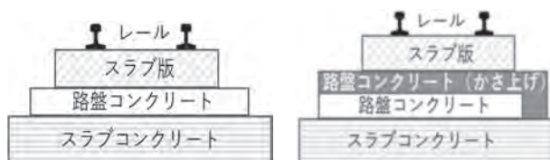
図—9 軌道構造概略図
