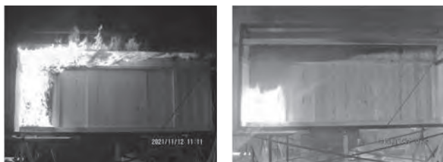
(a) 放水前 (b) 放水後 写真一七 火災進展抑制性能試験の様子
