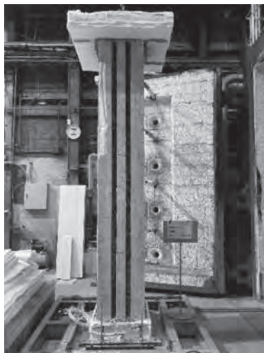
写真一三 3時間耐火認定試験終了後の柱試験体
