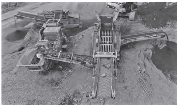
写真三 災害土石の選別・破碎再資源化処理
