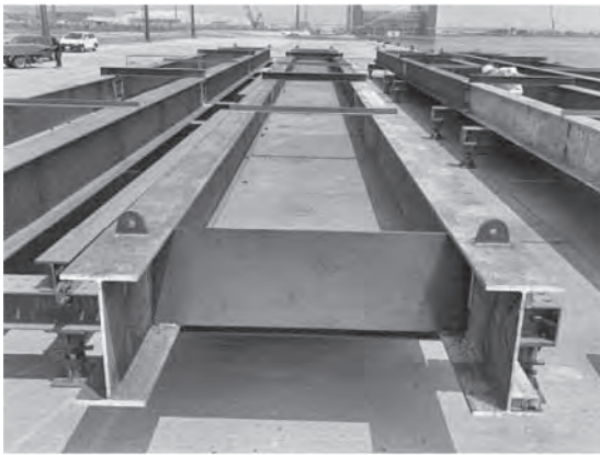
図-5 減揺タンク
