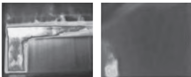
(a) 放水前 (b) 放水後 写真一八 火災進展抑制性能試験の熱画像
