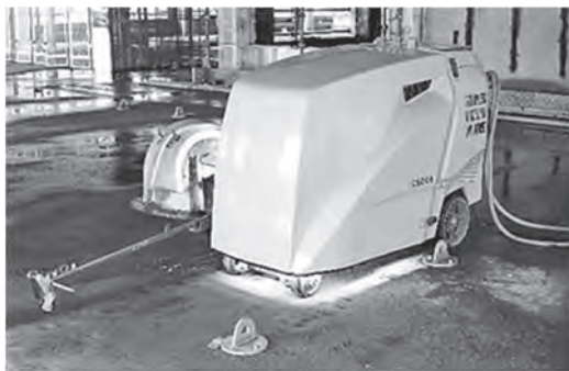
写真-2 スラブ斜め切断カッター
