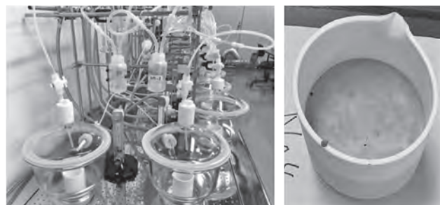
(左) 測定状況、(右) 模擬コンクリート試験体 写真—1 アンモニア放散量の測定試験の様子
