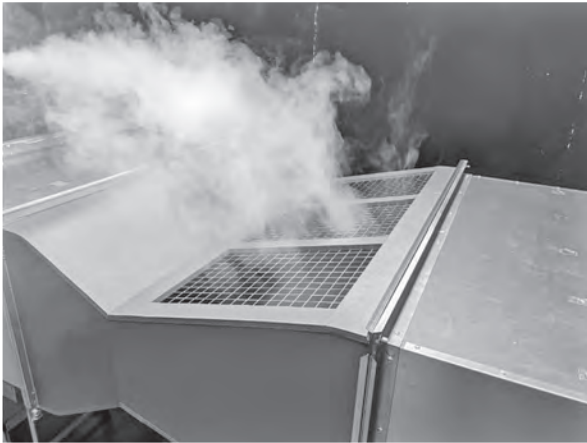
写真一 製品上下の誘引開口（気流吸い込み状況）
