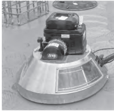
写真一七 完成した防音カバー
