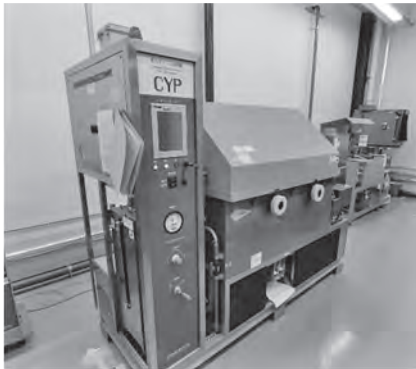
写真-12 塩害等の複合サイクル試験機
