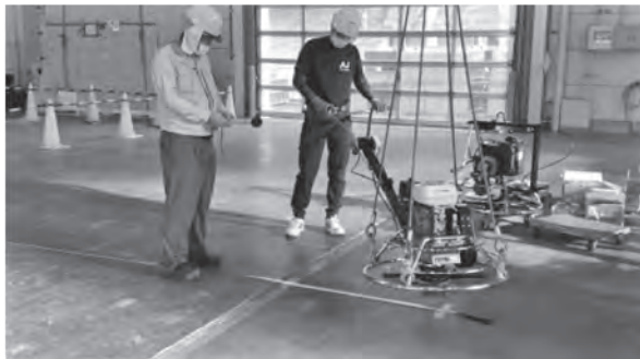
写真—3 通常のハンドトロウエル（エンジン） 1 mでの測定で87.5 dB 20 mでの測定で74.9 dB
