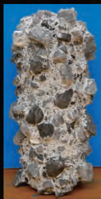
3体平均の 質量減少率48% (a) セメントコンクリート
