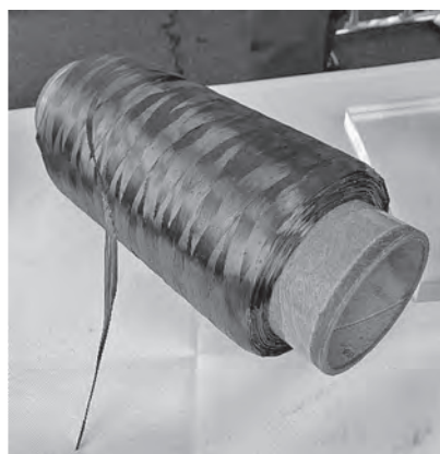
写真一 3 トウプリブレグ (TPP) 工程内端材
