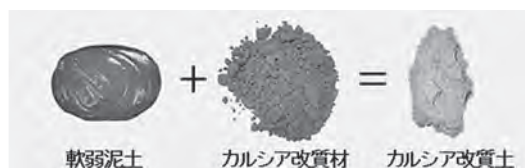
図—1 カルシア改質土の外観
