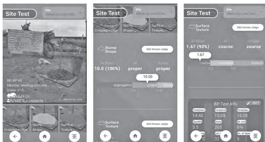
図—5 フレッシュコンクリート診断結果の例
