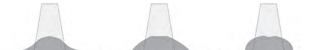
図—2 スランプ形状の模式図（左：分離気味、中：適正、右：粘性過剰）
