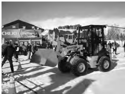
写真—20 (株)カナモト タイヤショベル 0.4 m 3 , 接触防止センサー付
