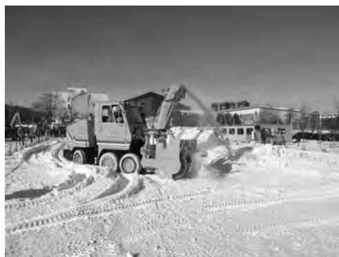
写真—23 (株)NICHIOJ ロータリ除雪車 (HTR308A), 小型除雪車 (KBR108)
