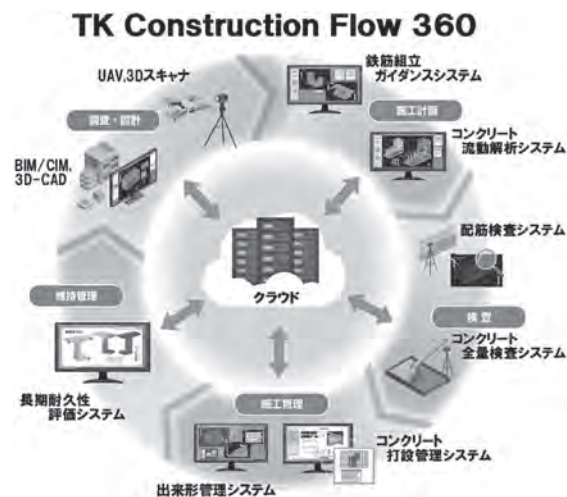
図—12 TK Construction Flow 360 概要図
