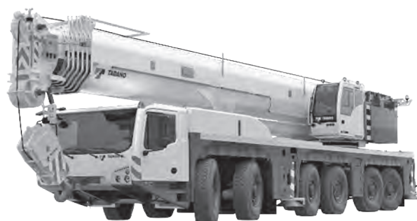
写真ー2 タダノ AC 6.300-1 オールテレーンクレーン
