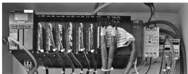
写真—4 吹付けロボット制御用 PLC (プログラマブルロジックコントローラ)
