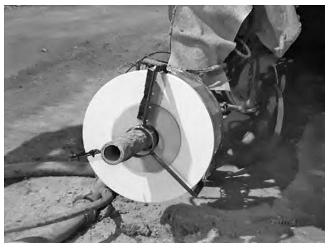
写真ー1 回転機構を有したレドーム
