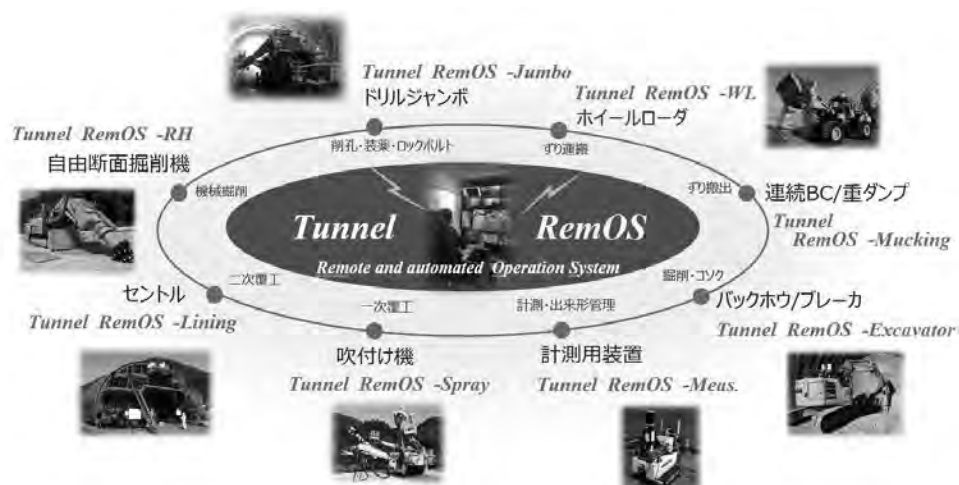
図一 山岳トンネル工事の各種建設機械の遠隔化・自動化
