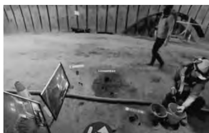
写真5 岩片のハンマー打撃音の確認
