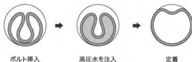
図—1 鋼管膨張型ロックボルト 1)
