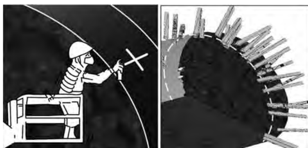
図—11 従来の打設位置マーキングと打設精度
