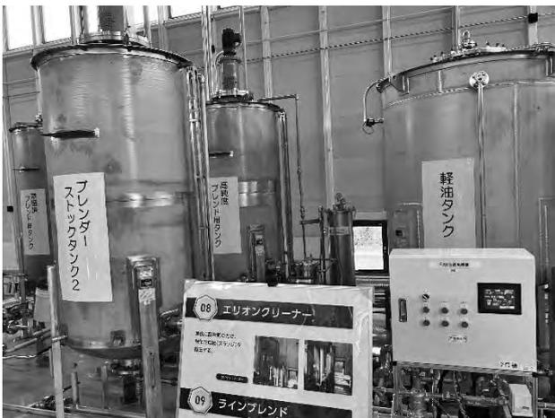
写真—5 軽油、重油との混合用設備
