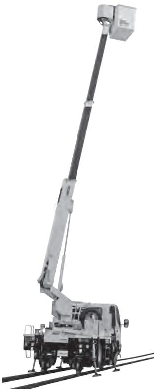
写真—1 アイチコーポレーション スカイマスター LK12C1FN 軌陸両用高所作業車
