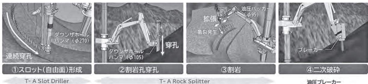
図-6 硬岩掘削フロー
