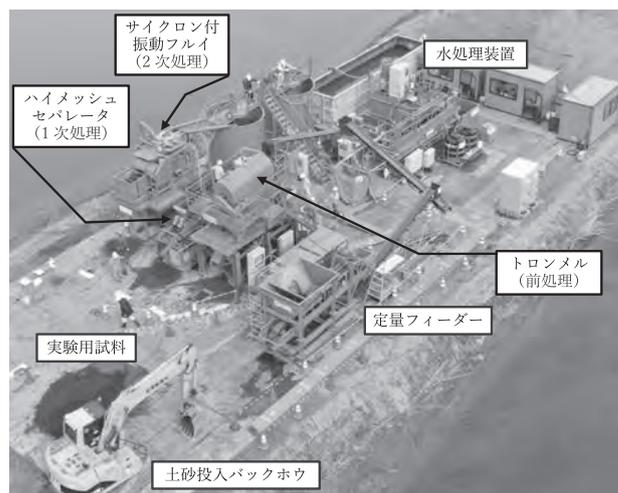
写真—1 ダム堆砂分級工法のシステム一例
