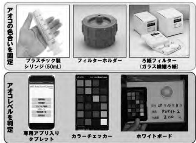
図-4 WEC 式アオコレベルチェッカーの概要
