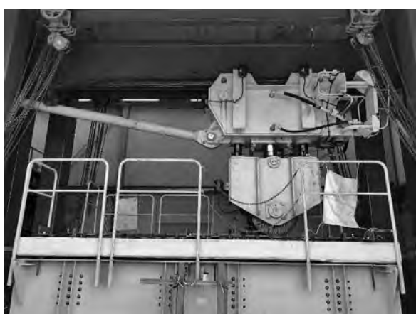
写真—3 輪荷重走行試験状況
