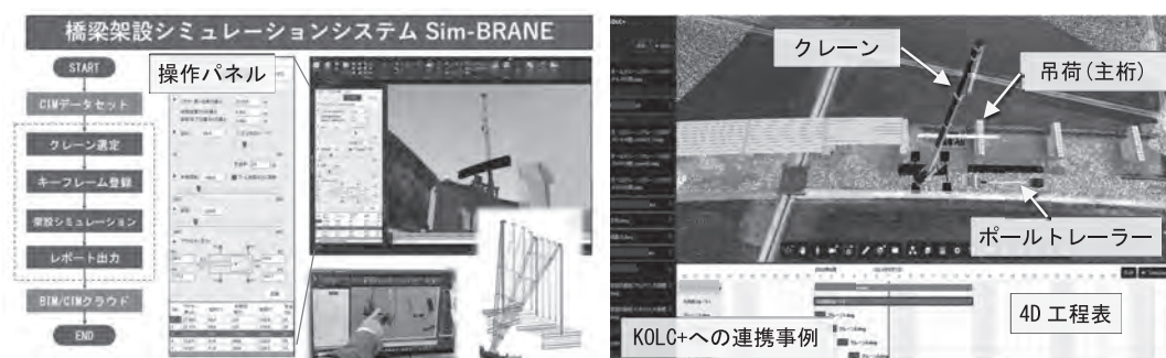
図—7 橋梁架設シミュレーションシステム Sim-BRANE
