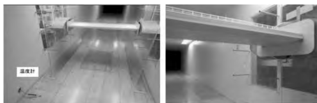
写真一3 主桁ばね支持試験
