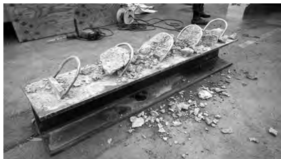
写真－1 ジベルリングに沿って形成された破砕面
