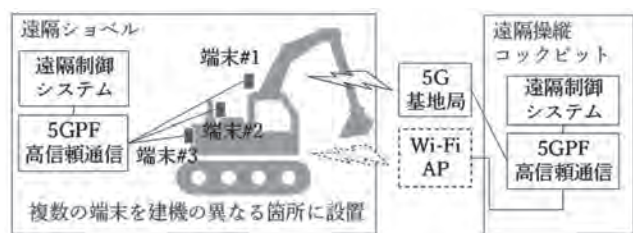
図—8 高信頼通信の建機適用
