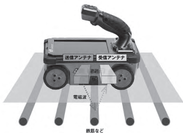
図一2 電磁波レーダ測定原理
