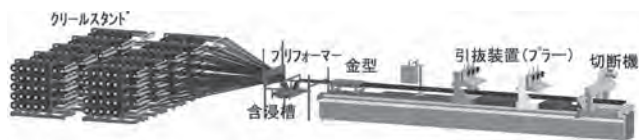
図一 2 引抜成形概念図
