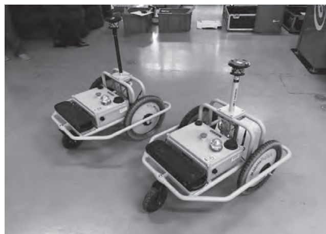
写真一1 自動マーキングロボット
