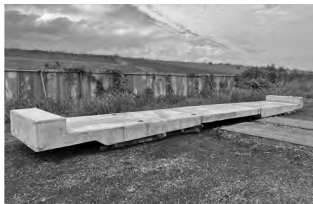
写真－3 製作した模擬床版
