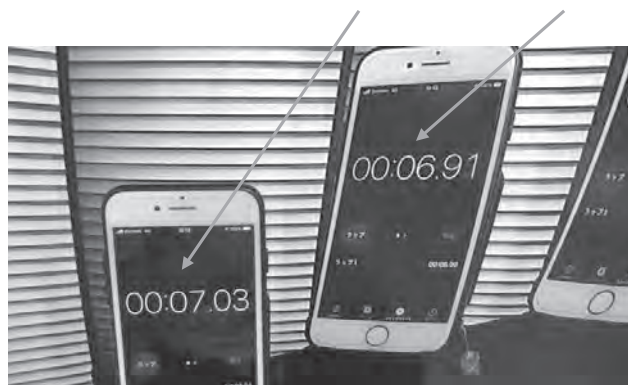
図—5 映像のE2E遅延時間測定結果
