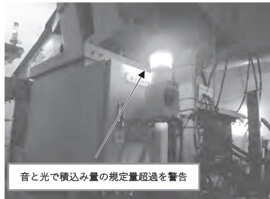
写真-4 センサによる積込み量警告状況
