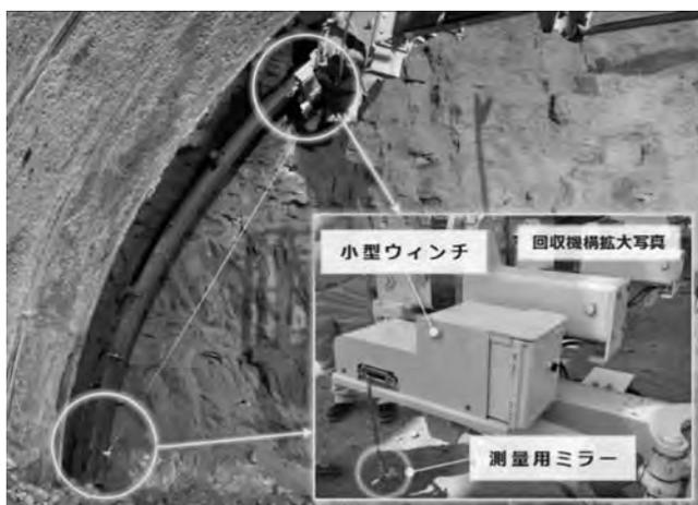
図—6 ミラー自動回収機構の適用状況
