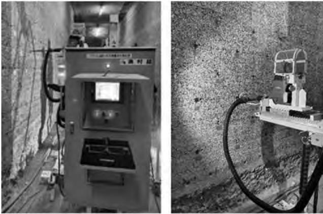
(a) 小径用自動削孔装置
