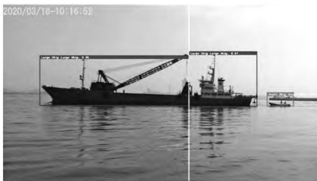
図一 12 システム画面例 (逆行時の船舶検知状況)
