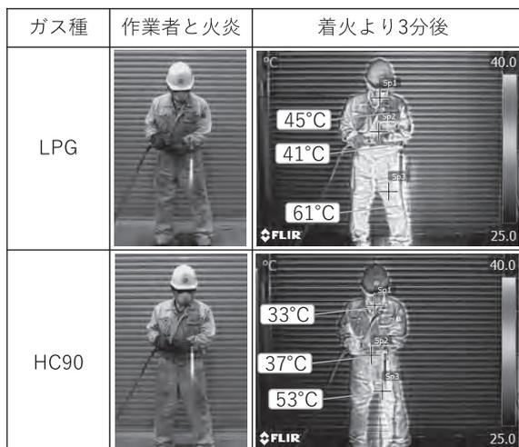
図-7 切断ガスの火炎による熱影響比較
