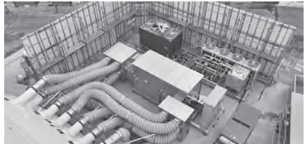
写真-4 炭酸化養生装置の外観
