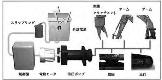
図一1 有線電動式機械の構成概要
