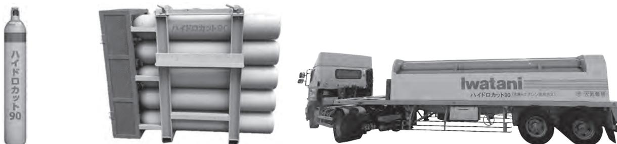
写真-1 HC90 ボンベ、カードル、トレーラー
