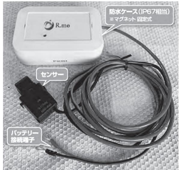
写真-1 本IoTデバイス(建設機械稼働時間把握装置)
