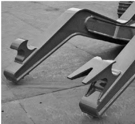
写真一3 押さえ込み用クランプアーム (自動車解体機)
