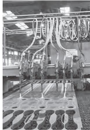
写真-4 NCガス切断機
