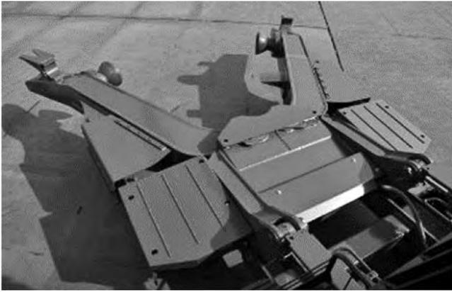
写真一2 開閉式クランプアーム (マルチ解体機)
