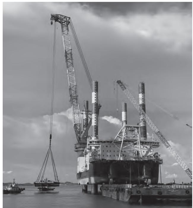
写真-2 メインクレーンの荷重試験
