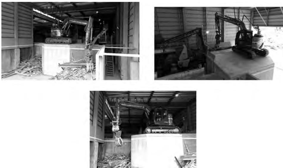
写真一七 13tクラスによる木材ハンドリング作業
