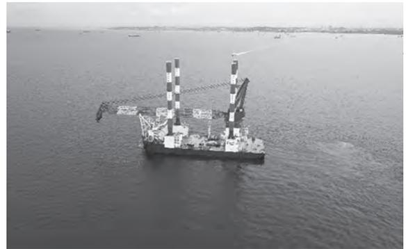
写真-4 自動船位保持装置の試験
