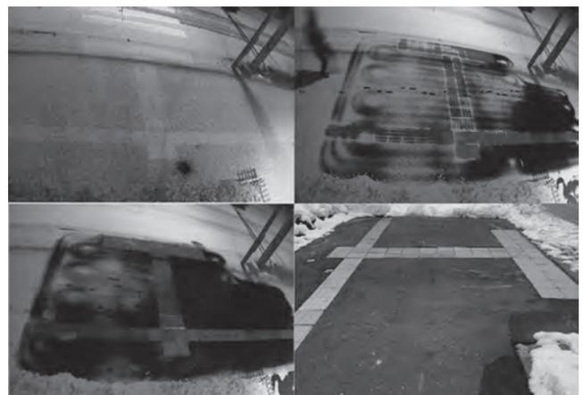
写真-2 ヒートポンプ式システム 融雪状況
