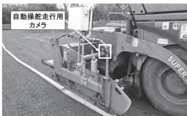
写真ー6 自動操舵走行用カメラ
