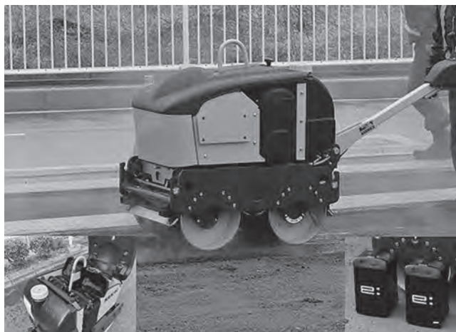
写真-3 着脱式可搬バッテリーを搭載した電動油圧式ローラの例
