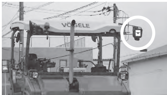
写真—5 ダンプ誘導装置のインジケータ表示（白丸部）
