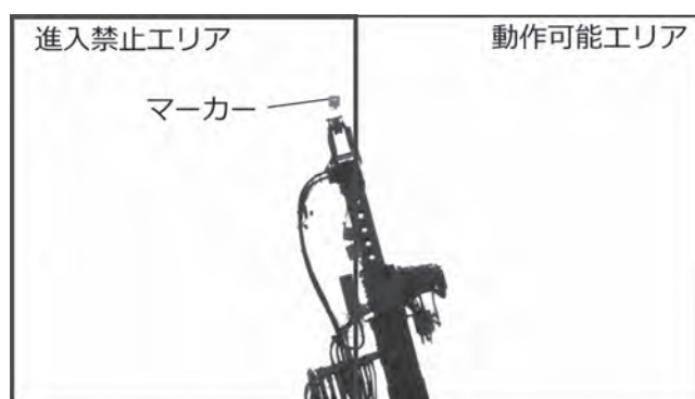
図—10 ボーリングマシン自動停止実験結果
