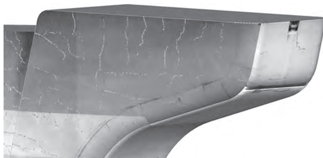
図一 5 本技術により得られたひび割れ図を 3 次元表示した例 4)
