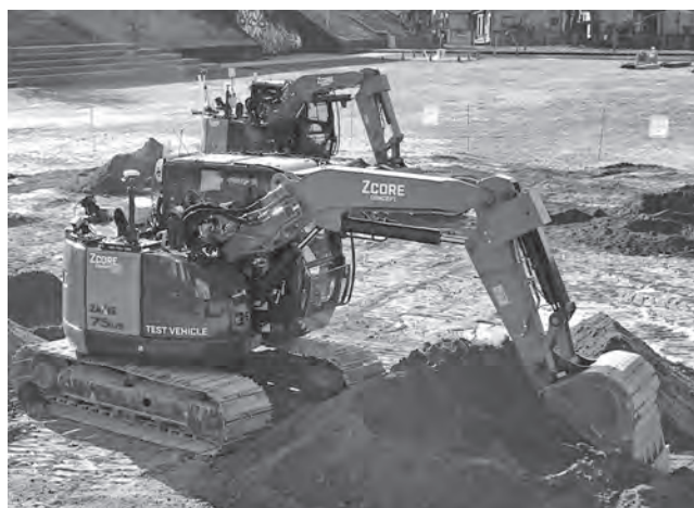
写真—2 自律型油圧ショベル（外観）
