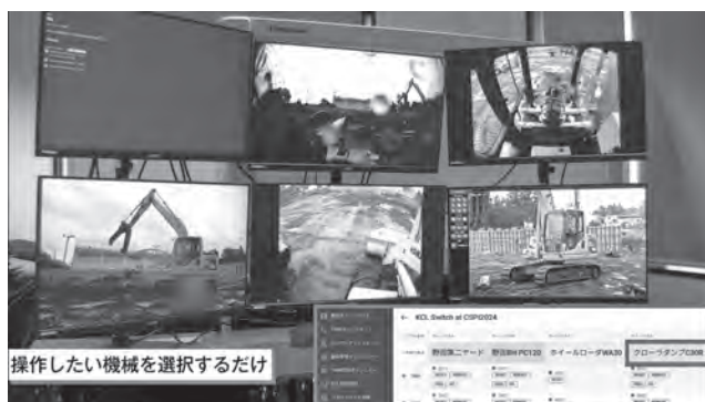
図—2 切り替え操縦の様子（建設機械②）
