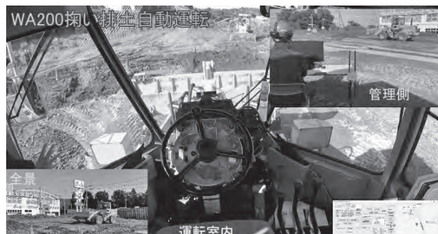
写真-7 ホイールローダー自動化開発状況
