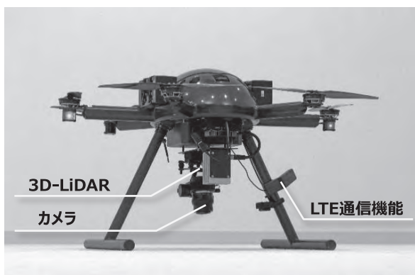
図ー2 土量検収ドローン搭載機器
