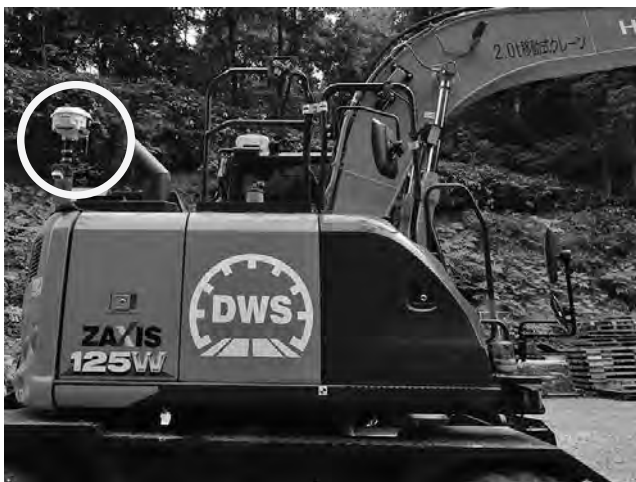
写真―8 3DMG 用 GNSS アンテナ搭載
