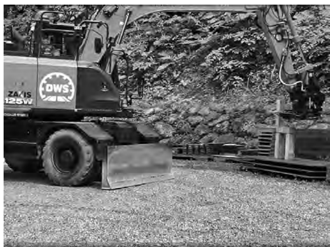
写真—3 チルトローテータのグリッパ使用時
