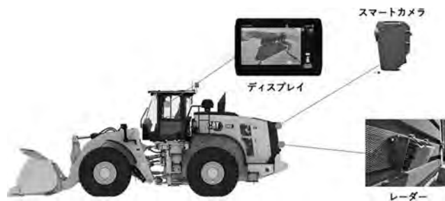
図-3 人検知機能 構成図
