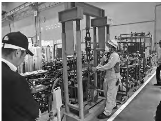
写真一七 吊り上げ荷重検査装置
