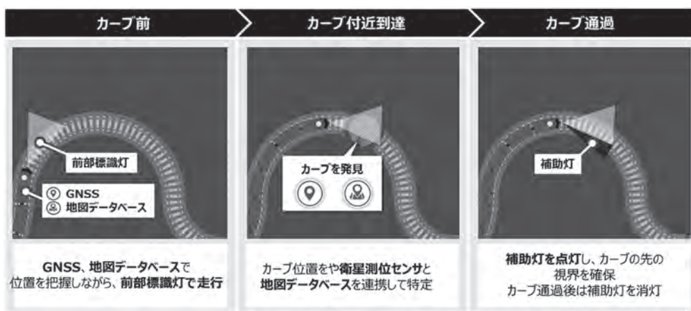
図一 5 カーブを通過する際の補助灯の動作イメージ
