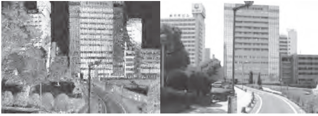
図-2 反射強度で表現された点群データ（左）と画像データ（右）
