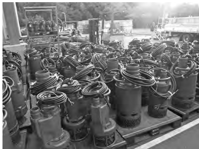
写真一八 整備済みの水中ポンプ
