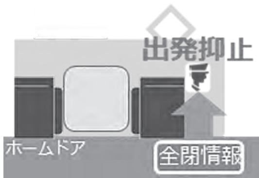
図-2 ホームドア条件による出発抑止
