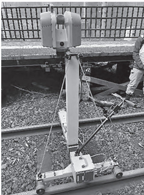
写真—4 手押し型レーザ計測装置
