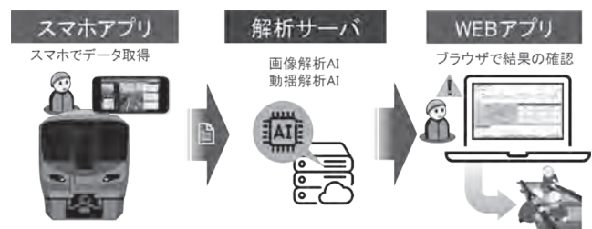
図-1 スマート動揺判定アプリのシステム構成
