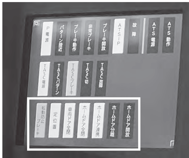
写真一三 運転台表示器例 (E233系 8000代)
