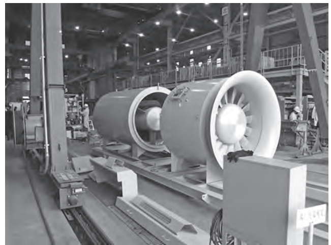
写真—4 整備中の大型送風機
