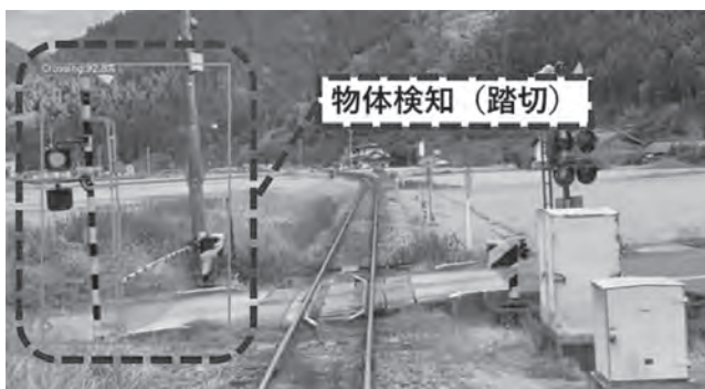
写真-3 物体検知の例 (踏切の場合)
