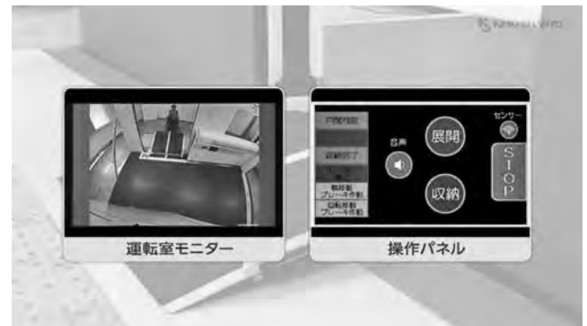
写真-1 運転室に設置するカメラモニターおよび操作パネル
