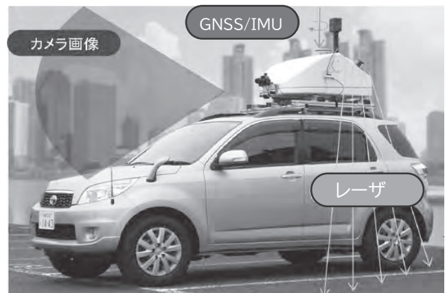
図-1 MMS計測装置
