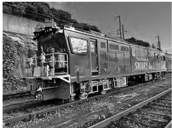
写真—1 新幹線線路設備モニタリング車
