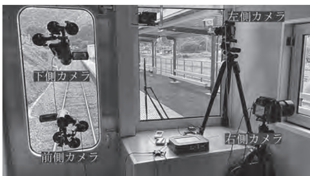
写真-2 列車内4方向カメラ設置状況
