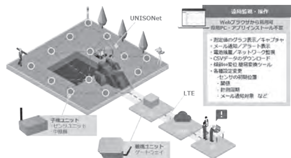
図—2 本IoT無線を用いた計測システム概要図
