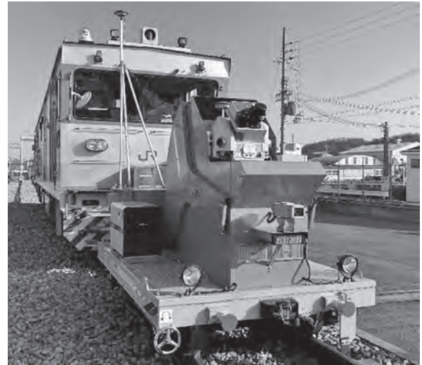
写真-1 鉄道MMS専用台車の外観
