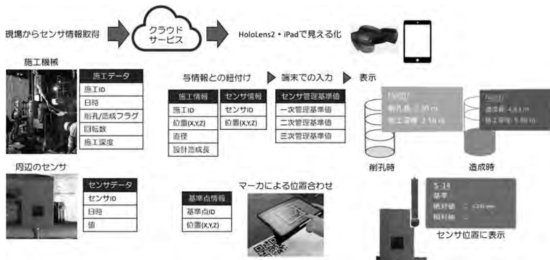
図二 システム構成およびデータ構成概要
