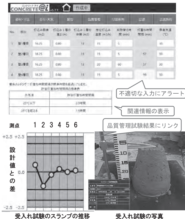
図-2 打設計画支援システムの概要
