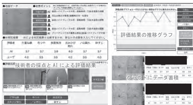
図一七 表層品質 AI 目視評価システム 9)
