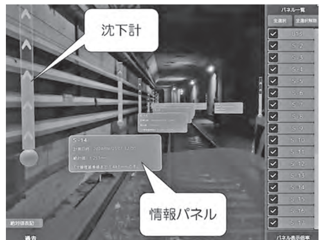
図-11 沈下計モデルの表示
