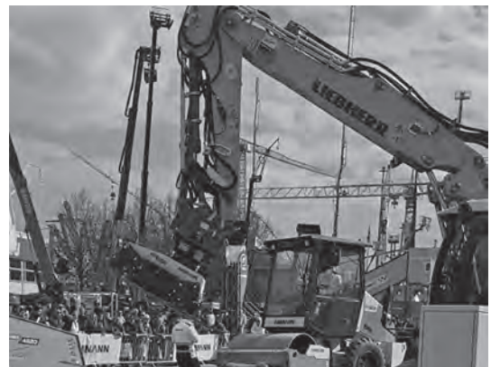
写真—20 タンパのアタッチメントを付けたバックホウ (AMMANN のデモ)
