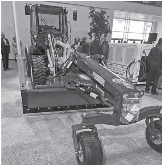
写真-25 ホイールローダに設置されたグレーダのアタッチメント
