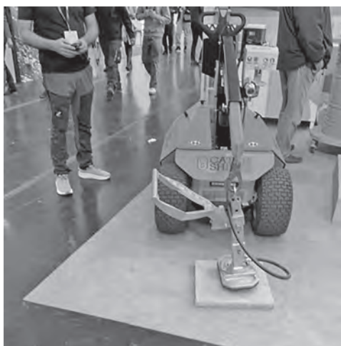
写真—35 吸引式のブロック搬送装置
