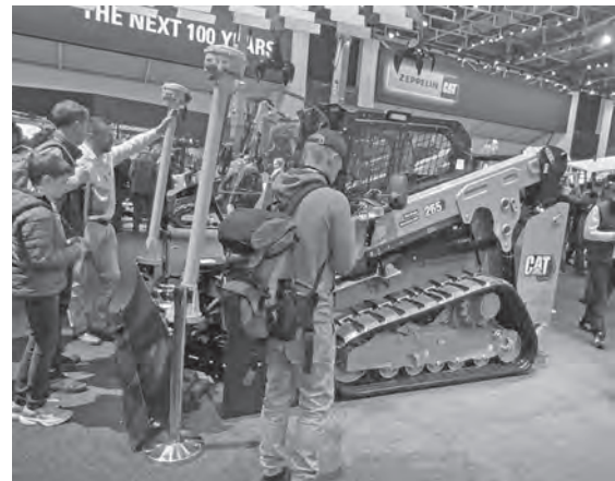
写真—24 スキッドステアローダに設置されたドーザのアタッチメント
