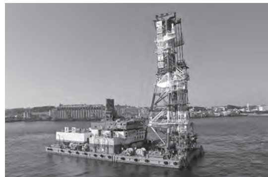
写真一3 環境配慮型深層混合処理船
