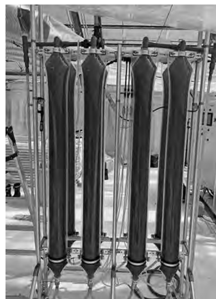
写真-2 樹脂バッグ型藻類培養装置
