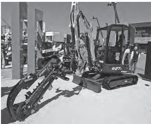
写真—22 油圧ショベルに設置された様々なアタッチメント
