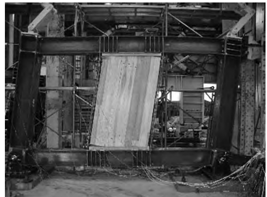
写真-2 構造実験 (CLT耐震パネル)
