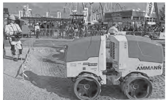
写真—21 遠隔操作の小型ローラ (AMMANN のデモ)
