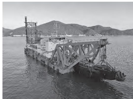
写真一1 ポンプ浚渫船
