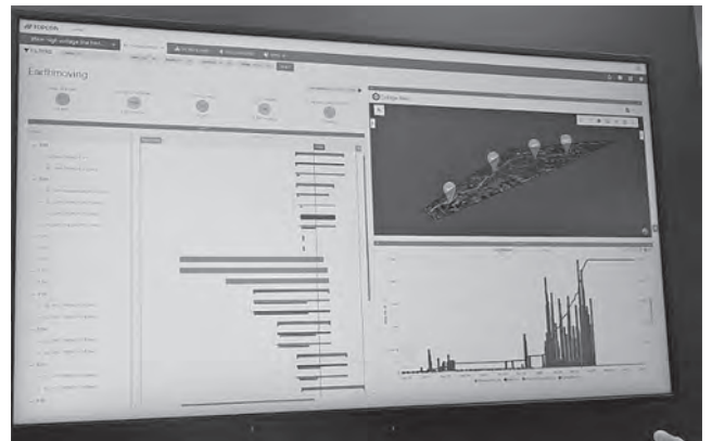
写真-28 建設機械の稼働履歴から得られる地形データによる工程管理システム (TOPCON)
