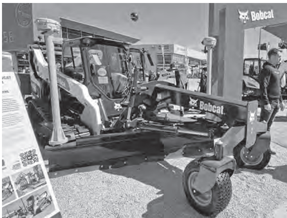
写真—23 スキッドステアローダに設置されたグレーダのアタッチメント
