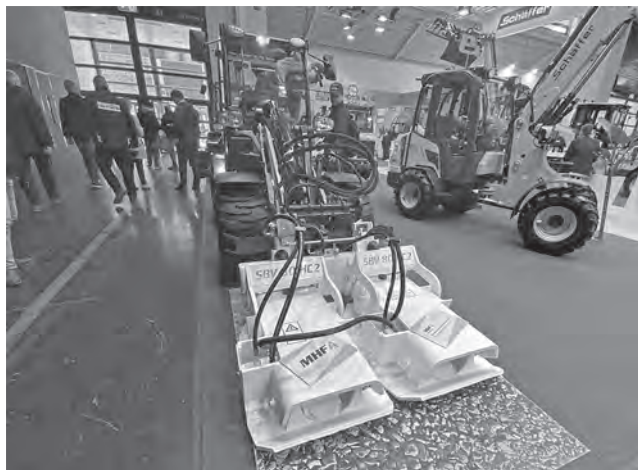
写真-26 ホイールローダに設置された締固めのアタッチメント
