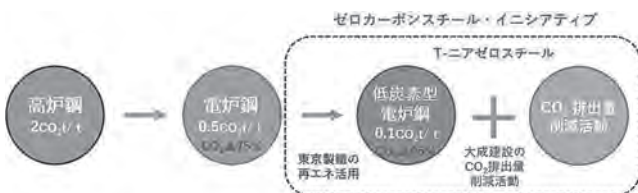
図一七 脱炭素化に向けたプロセスとゼロカーボンスチール・イニシアティブ
