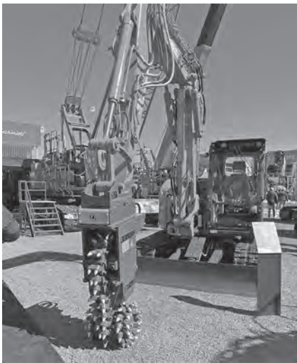
写真—13 チェーンカッターを装着したショベル (KOBELCO)
