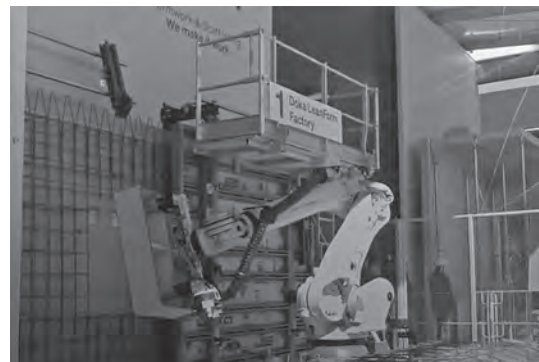
写真—31 鉄筋や窓枠を自動配置するロボットアーム (DOKA)
