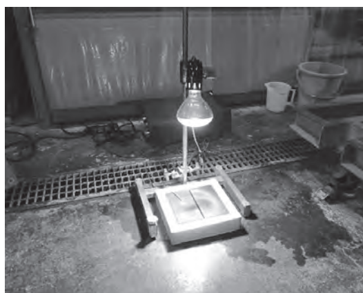
写真一 6 吸水した IL ブロックの表面温度測定状況
