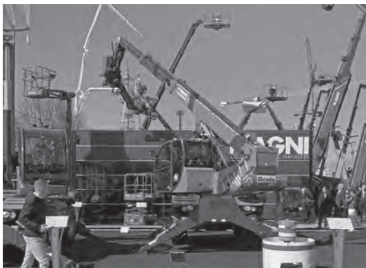
写真—17 クレーン先端に壁面把持装置を装着した機械
