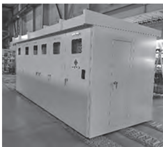
写真一 2 配電盤
