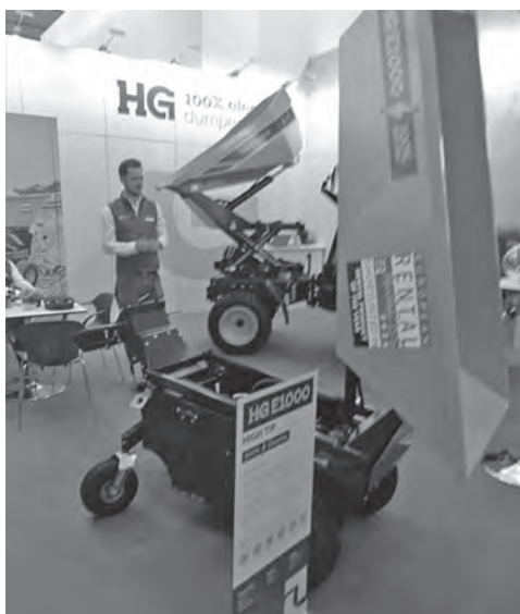
写真—34 一輪車替わりのリモコン台車
