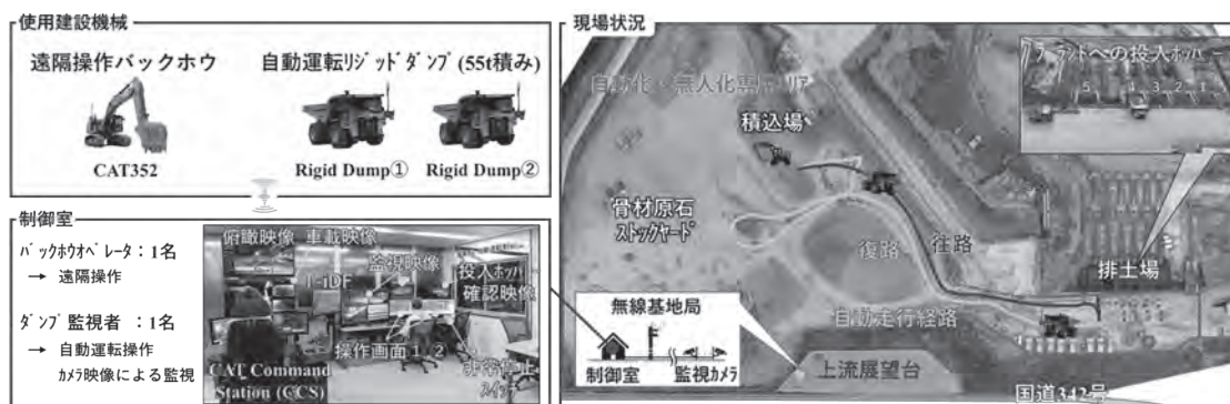
図—4 自動運転システムの設備概要
