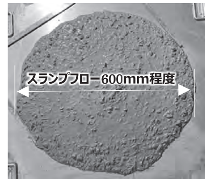
覆工用高流動コンクリート
