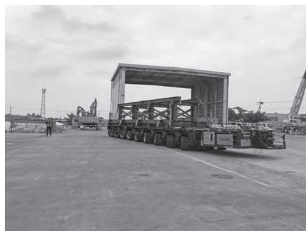
写真—1 多軸台車、運搬架台
