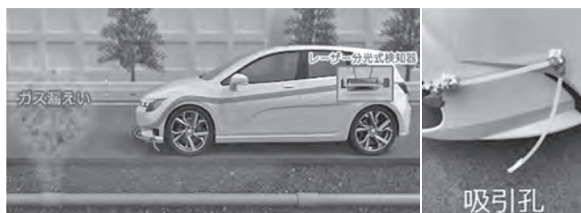
写真—2 自動車型検査車両とバンパー部の吸引口
