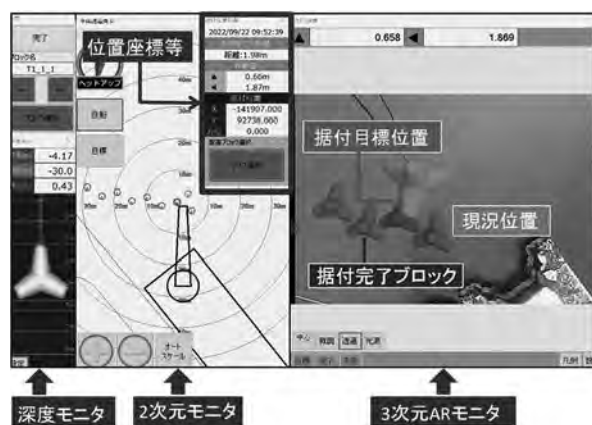
図-7 ブロック据付ARガイダンスシステム 5)
