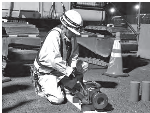
写真ー8 ポータブル試験機による圧縮強度試験
