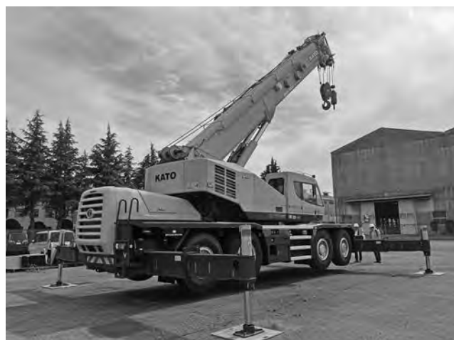
写真—2 ラフテレーンクレーン
