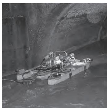
写真—8 〔調査事例2〕船体式テレビカメラ調査の様子と確認した異状箇所（管路内面の腐食あり）
