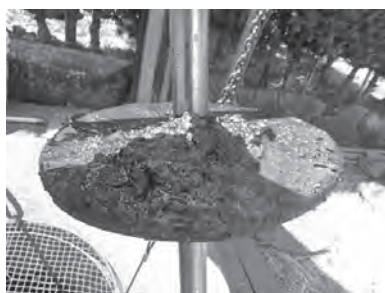
写真—2 管表面に近い固着物
