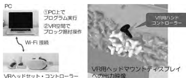
図—4 VR機器を用いたブロック据付
