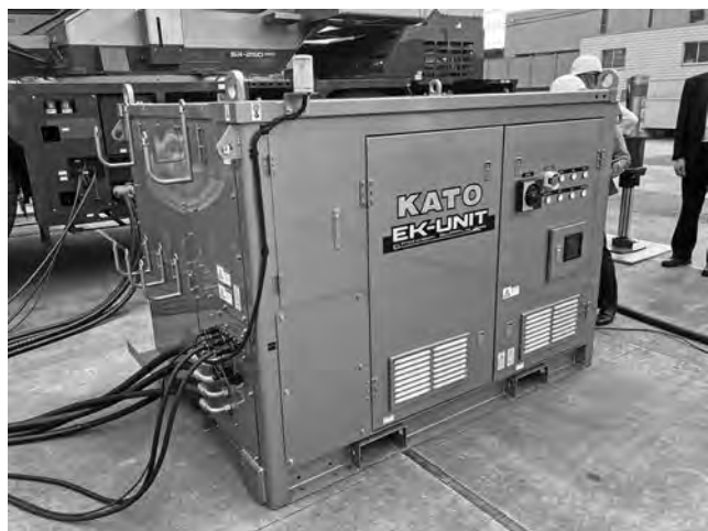
写真—5 EKユニット(電動油圧ユニット)
