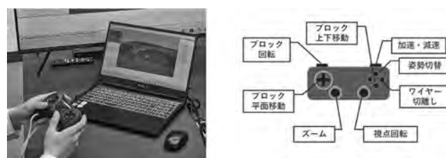
図—3 ゲームパッドによる操作
