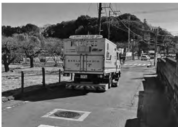
写真一 3 路面下空洞調査の様子（空洞探査車による調査）
