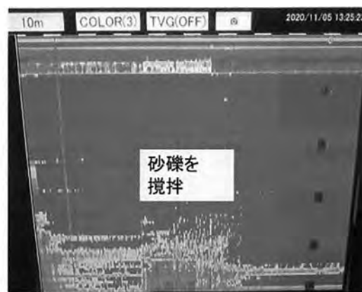
図一 3 砂礫投下時の超音波の透過度
