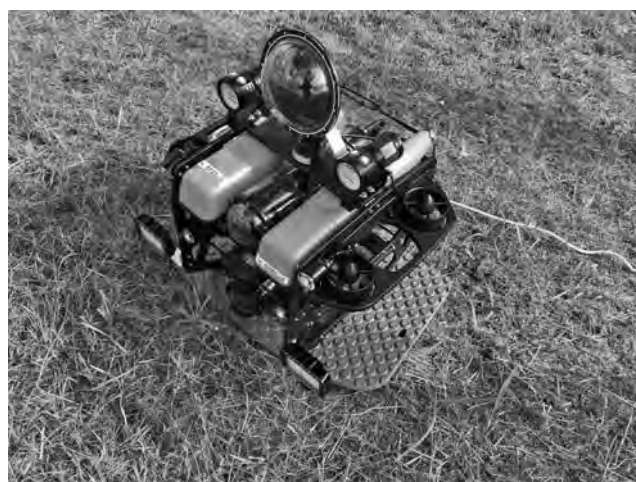
写真—5 カメラ・照明機器を搭載した水中ドローン
