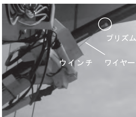
図一八 プリズム回収用ウインチとワイヤー
