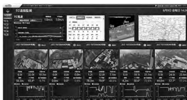
図一6 クレーン稼働状況可視化例
