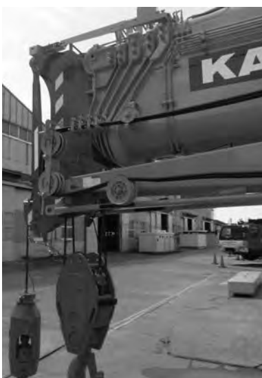
写真—6 本機種のホースガイド（設置完）
