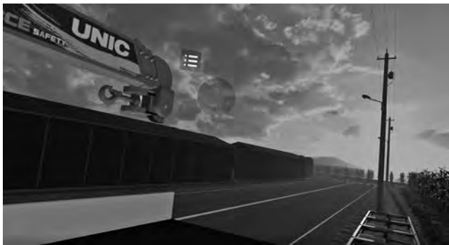
図ー3 高圧電線への接触による事故事例の一場面
