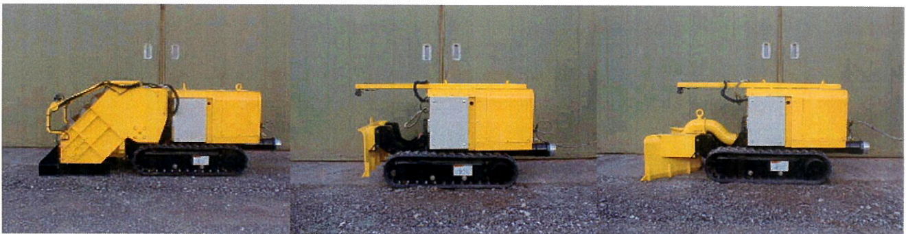
写真- 2 試作機完成写真 (左: トレンチャ式、中: 排土板式、右: 直接吸引式)
