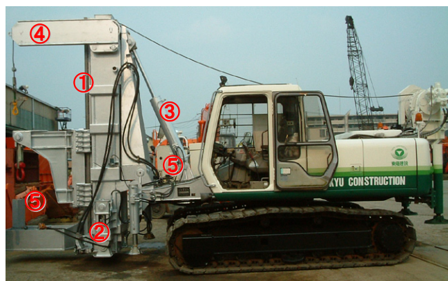
写真－4 TBX-200 建込機仕様（改造後）
