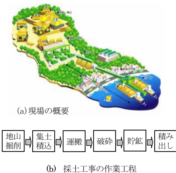
図-2 システムの構築を行った工事現場概要
