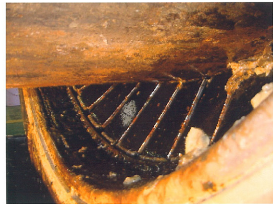
写真-4 止水状況(1.0MPa、偏心50mm)
