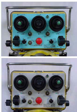
写真4 送信機（上が作業用，下が走行用）
