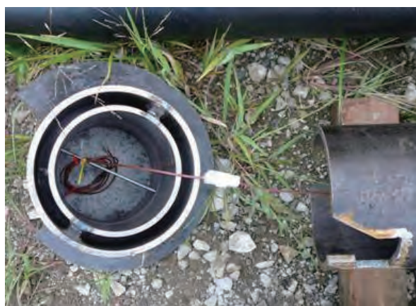
写真-2 先端部材の形状（改良したもの）
