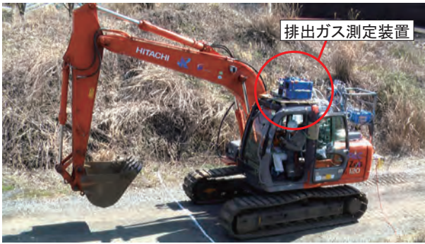
図-1 車載型排出ガス測定装置設置状況
