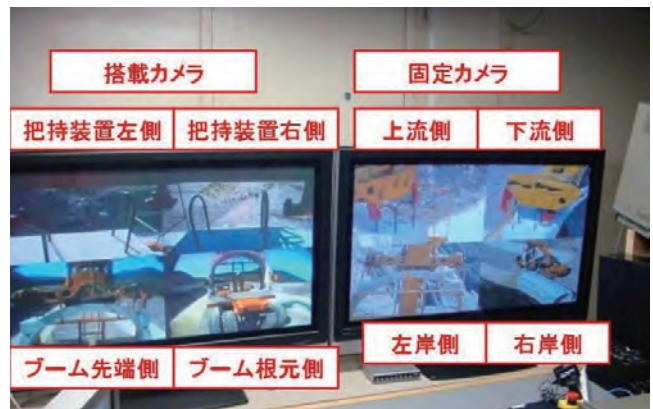
図-10 遠隔操作時のモニター状況
