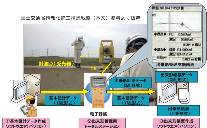
図-1 TS を用いた出来形管理技術
