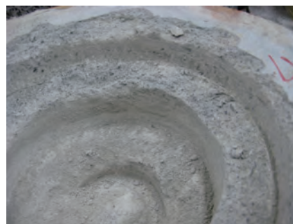
段階的に掘削が出来た様子
