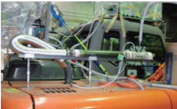
図-2 排出ガス流量計設置状況
