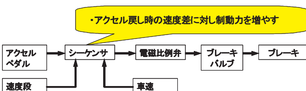
図7 オートブレーキシステム構成
