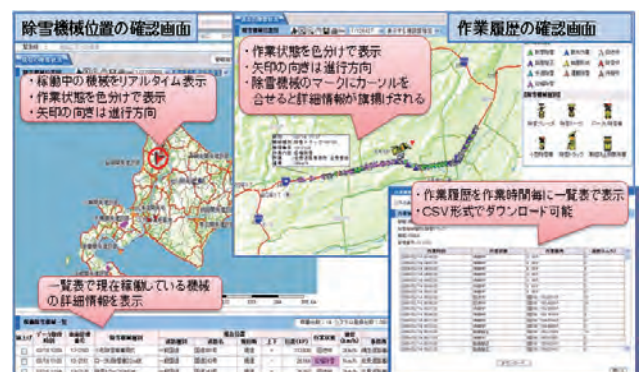
図-2 除雪機械位置・作業履歴の確認
