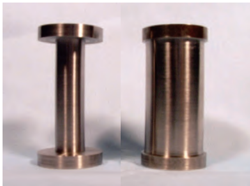
LC1 LC4 図-2 供試ロードセルの形状
