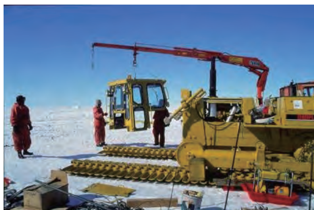
大陸上で組み立て中のブルドーザ
