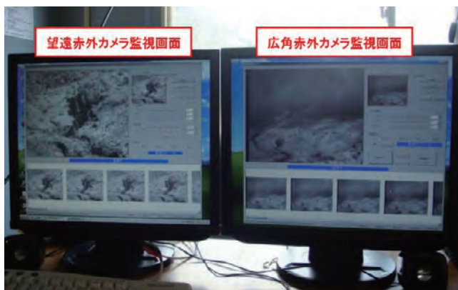
図-21 山体監視システム監視画面
