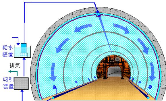
図-6 トンネルでの浸水養生システム構成
