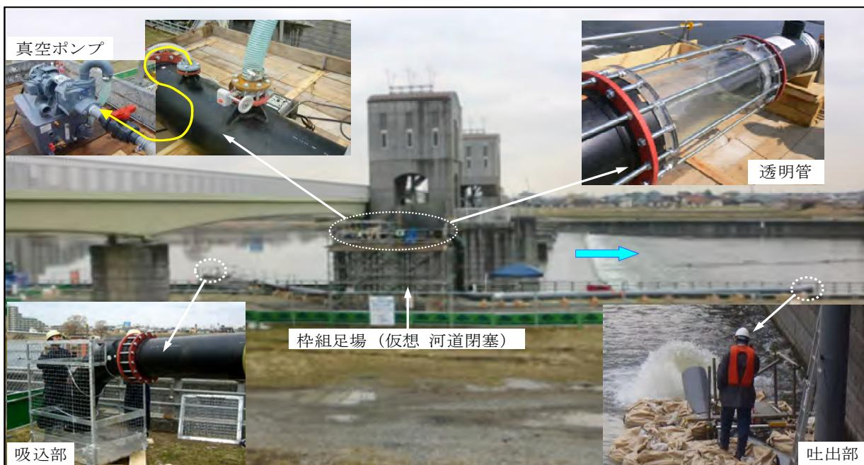
写真-1 モデル実験設備
