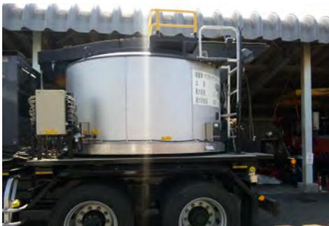
写真-4 クッキング釜チルト装置(傾斜前)
