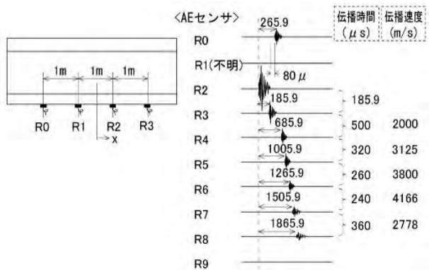
図-17 AE 発生位置の標定 (559kN 時)
