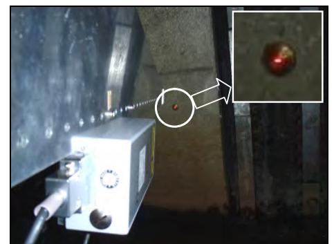
写真-10 測定鉛にレーザー光を照射している状況 (左)
