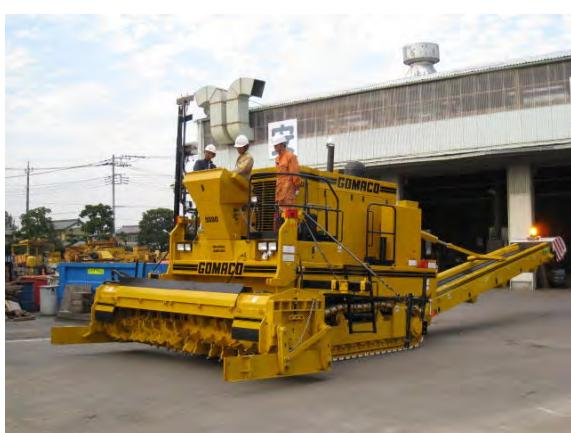
写真-1 地盤整正機全景
