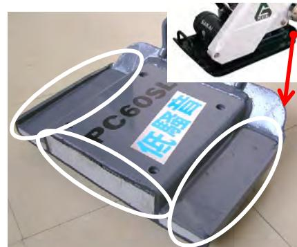
写真-2 制振材充填状況
