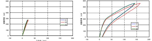
(a) 荷重ーたわみ(275kN 時) (b) 荷重ーたわみ(559kN 時)
