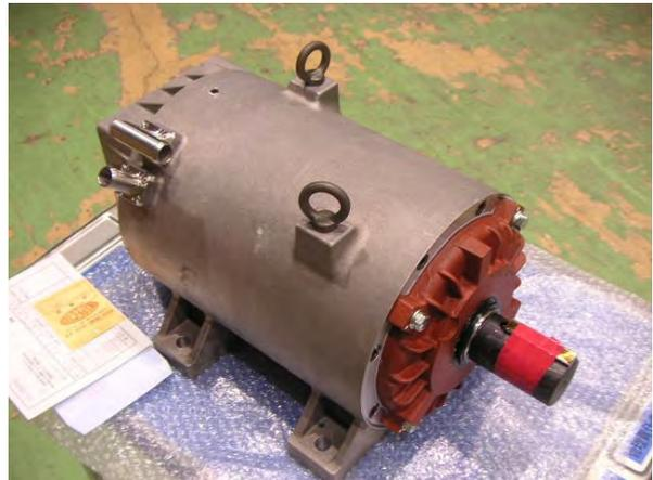
図4 電動モータ (永久磁石同期モータ)
