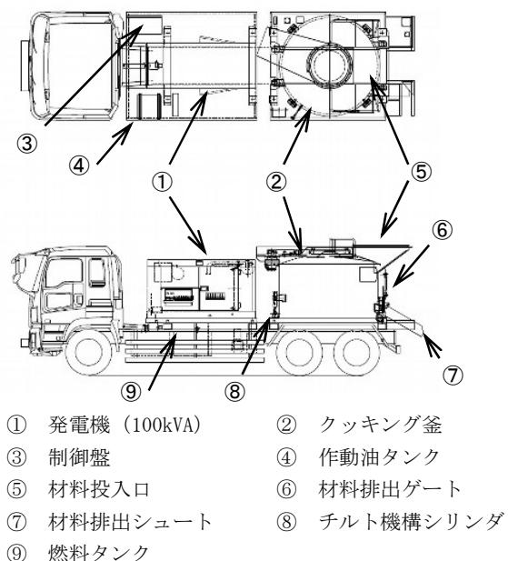
図-2 電気加熱式アスファルトクッカー車装置構成図
