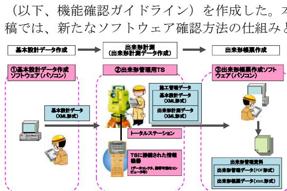
図-1 TSによる出来形管理のシステム構成
