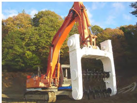
写真-8 DAM 機取付状況
