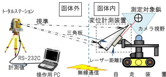
図-4 変位計測システム機器構成図
