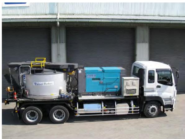
写真-2 電気加熱式アスファルトクッカー車外観写真
