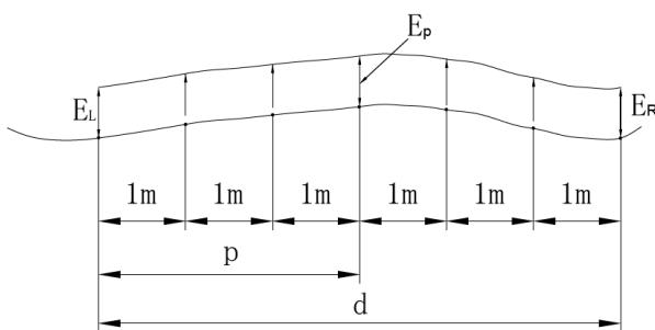
図-5 左端点から  $p$  の距離にある点の補正値を求める方法
