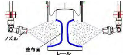
図-3 レール塗布の概念図
