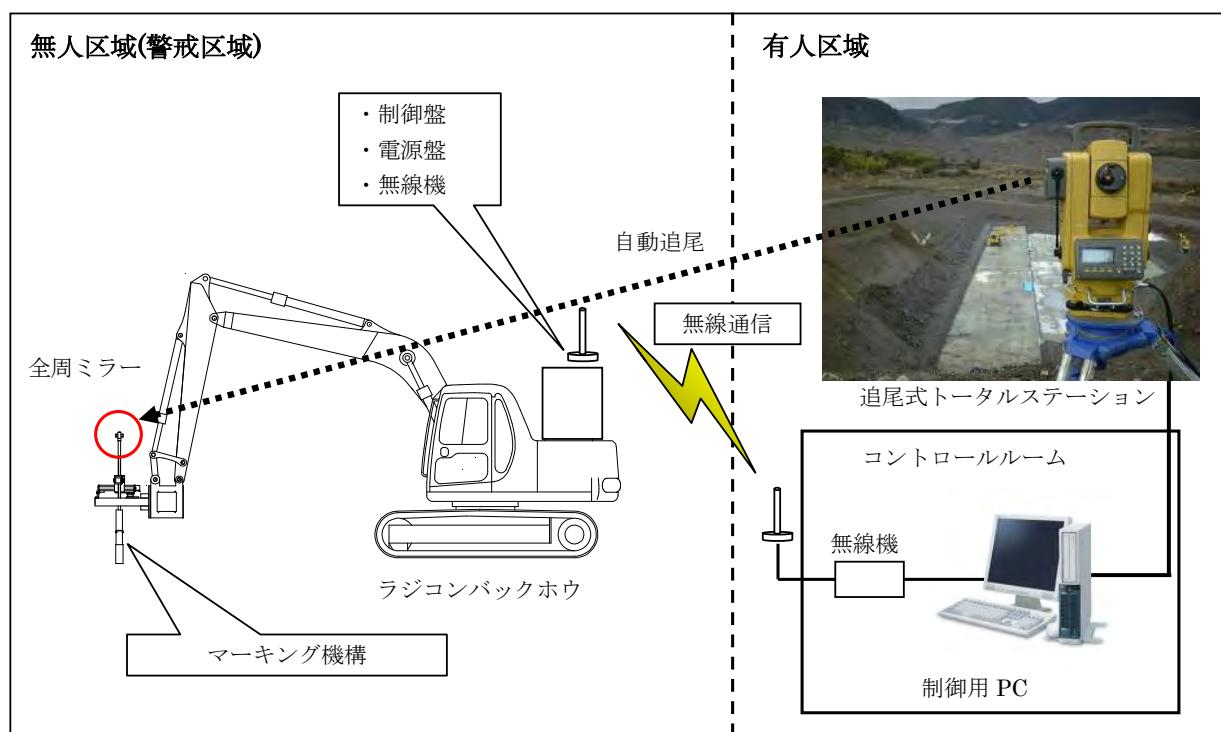
写真-1 無人測量システム概要図
