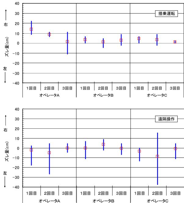
図-5 挖削時のバケットの左右方向ズレ量
