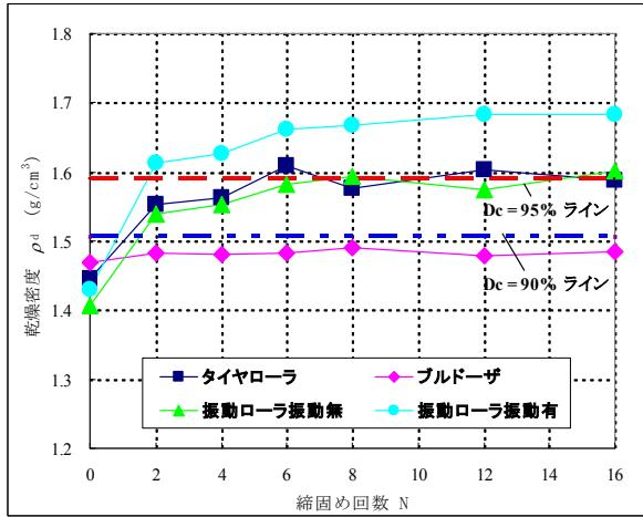
図-6. 乾燥密度—締固め回数 ( $h=200\text{-}300\text{mm}$ )
