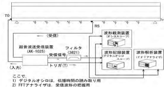
図-6 超音波計測システムの構成
