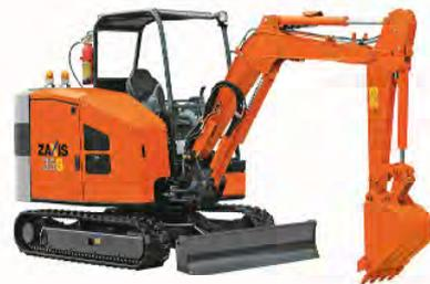
図1 バッテリーショベルの外観
