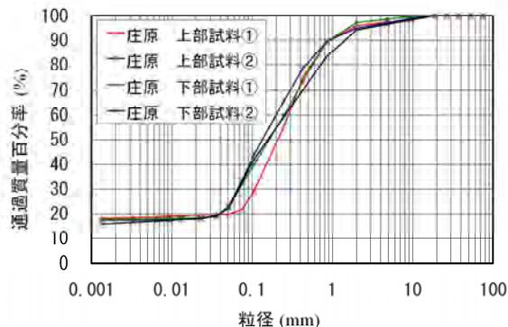
図-1 粒径加積曲線 庄原市
