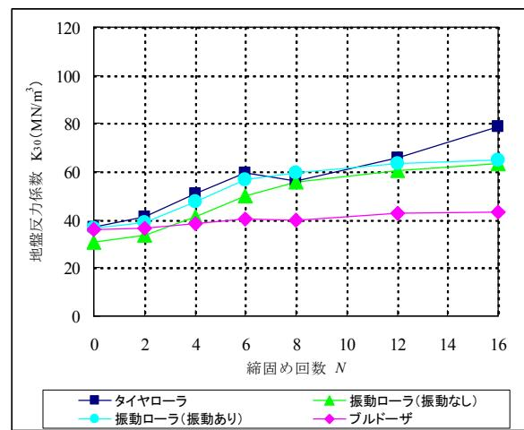
図-10. 地盤反力係数一締固め回数
