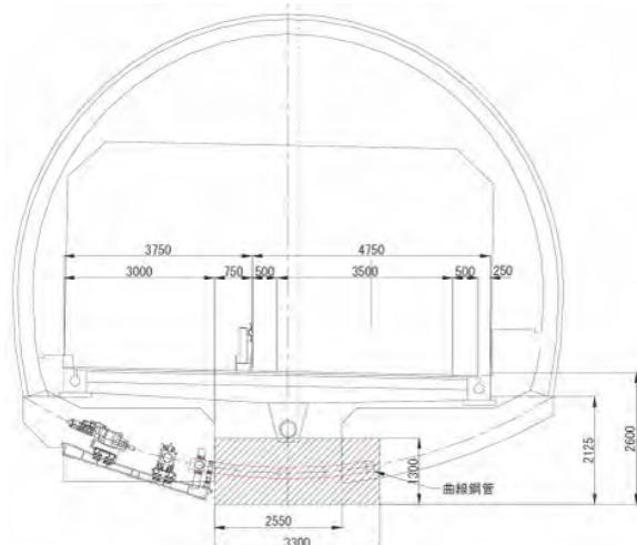
図-6 曲線钢管の打設イメージ
