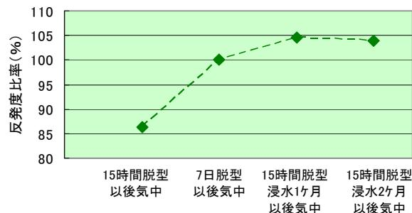
図-4 テストハンマー反発度
