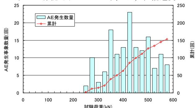
図-15 破壊試験時の AE 検知結果
