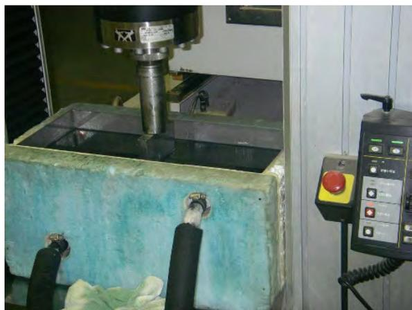
写真-7 供試体曲げ試験状況
