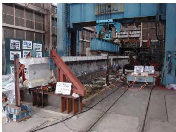
写真-1 プレテン桁の載荷試験状況
