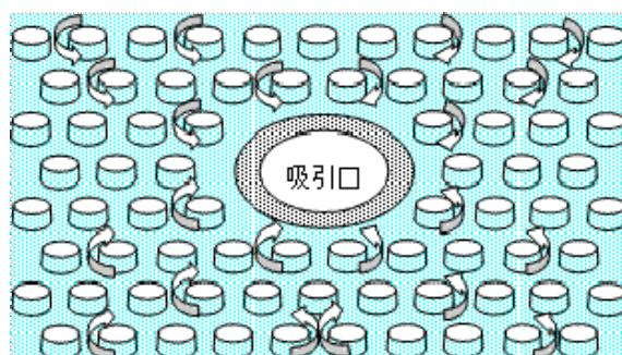
図-2 浸水養生シート内部の空気の流路
