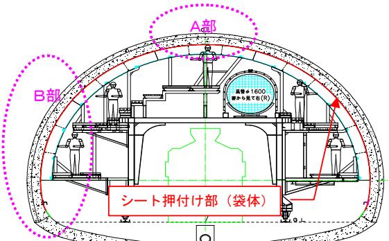
図-8 浸水養生シート展張台車概要図
