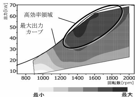
図-7 車両搭載状態での効率マップ
