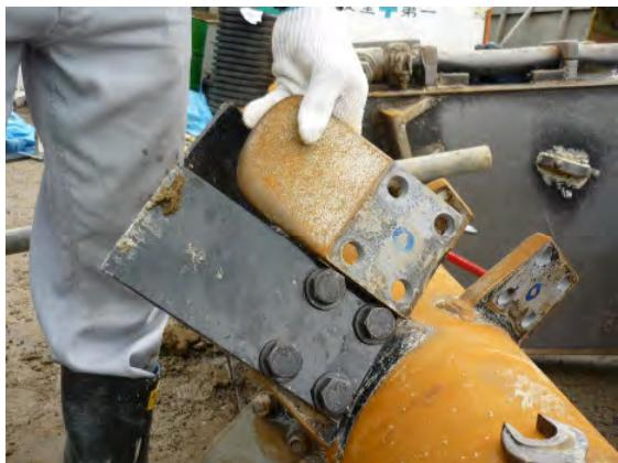
写真-9 DAM機の搅拌羽根交換状況
