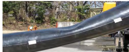
写真-4 高密度ポリエチレン管の変形状況
