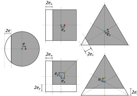
図 11 有効面積の算出方法の概念図
