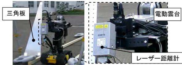
写真-4 変位計測装置
