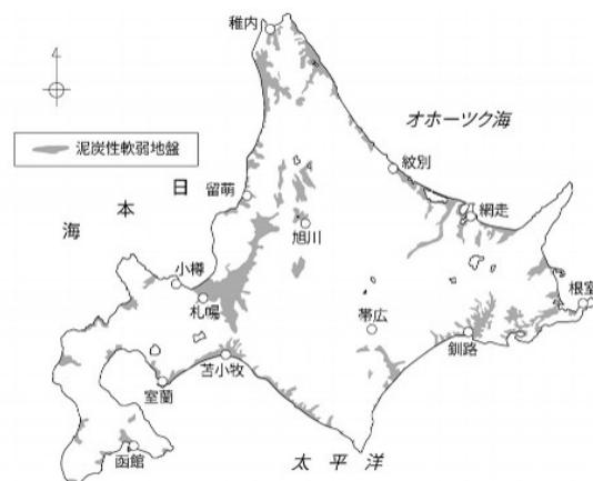
図-1 北海道の泥炭性軟弱地盤分布図<sup>1)</sup>
