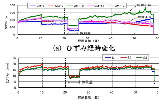
図-14 ひずみ・たわみの経時変化
