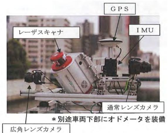
図-1 計測システムの概要
