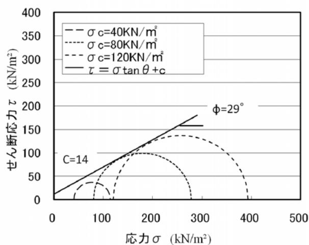
図-3 庄原市上部搅乱飽和のモール円による破壊線
