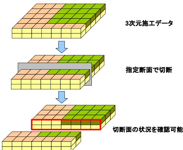
図-8 施工データの3次元表示の出力イメージ
