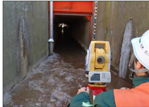
写真-7 函体内の変位計測装置を TS で視準している状況
