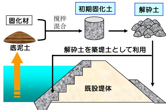
図-1 碎・転圧盛土工法の概念図
