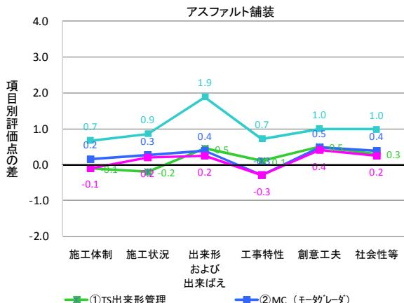
図-14 各技術の項目別工事成績評定点の差(As舗装)
