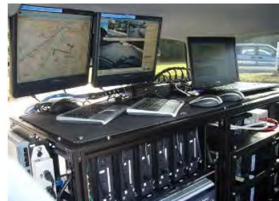
写真-3 MMS の車内搭載機器
