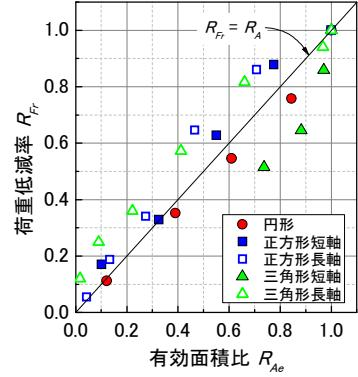
図 12 荷重低減率と有効面積比の比較
