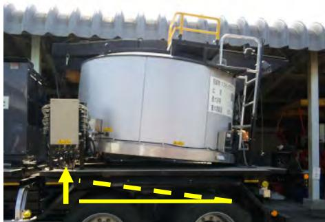
写真-5 クッキング釜チルト装置(傾斜後)
