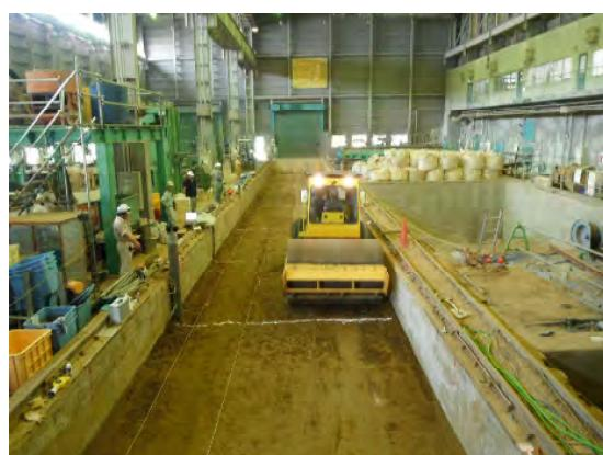
写真-4. 締固め回数試験状況
