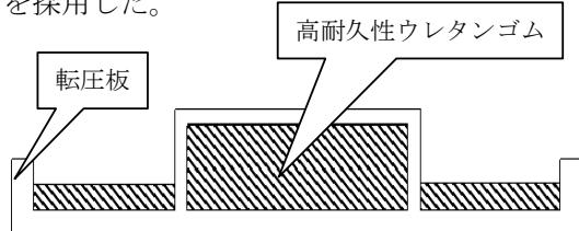
図-1 転圧板断面図
