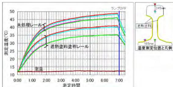
図-5 照射試験のレール温度測定結果例
