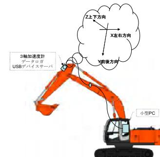
図-1 計測機器類の取り付け位置
