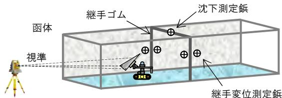
図-3 変位計測システムによる計測イメージ図
