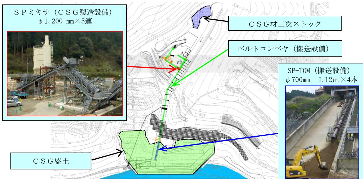
図-8 CSG 盛土 製造設備・搬送設備
