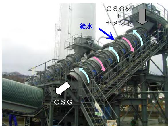
写真-1 混合筒5連方式のS Pミキサ
