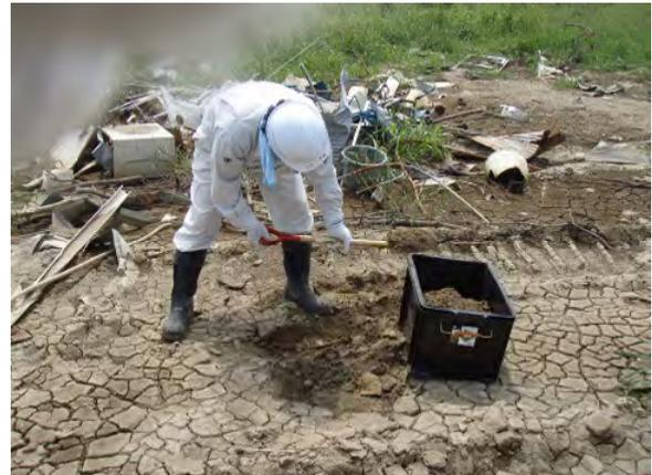
図-10 津波堆積物サンプリングの様子
