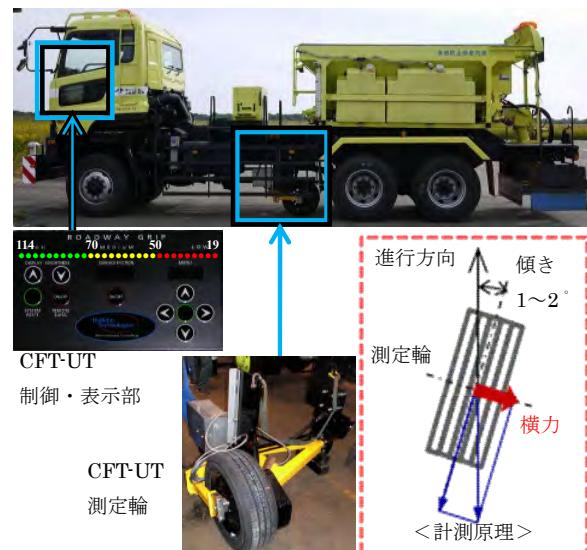
図-1 CFT-UT と CFT-UT を搭載した凍結防止剤散布車
