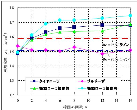
図-5. 乾燥密度—締固め回数 ( $h=100\text{-}200\text{mm}$ )
