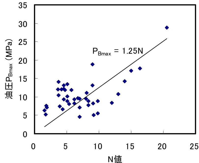
・標準貫入試験の結果もしくはスウェーデン式サウンディング試験から得られた値を換算したN値に基づく
