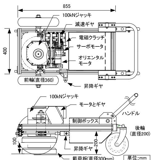
図1 現場支持力試験装置の概要
