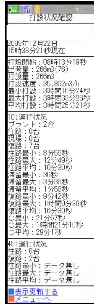
図-10 運行状況実時間遠隔監視情報
