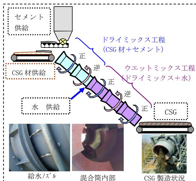
図-1 混合筒5連方式と各種設備内容
