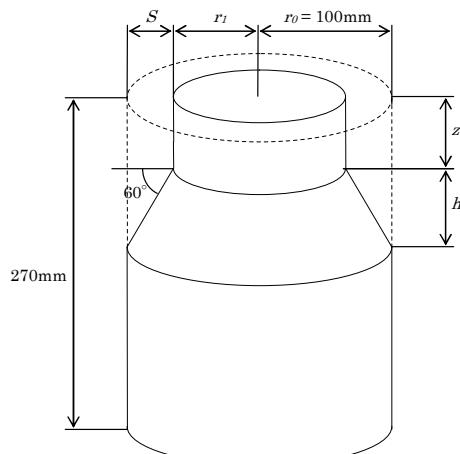
図-10 仮定する供試体の掘削断面
