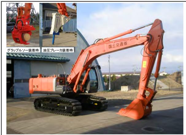
空輸対応型油圧ショベル(1.0m<sup>3</sup>級) 全景写真
