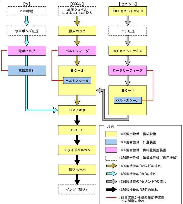
図-3 C S G 製造設備の製造フロー
