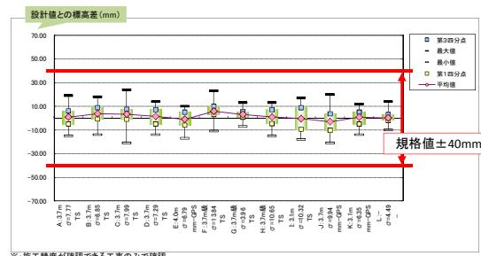
図-14 MC（モータグレーダ）技術による施工精度 (下層路盤工)
