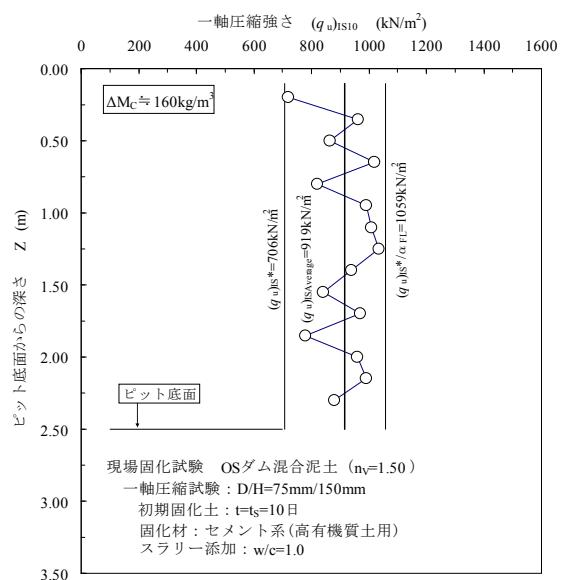
図-9 固化ピット内深さ方向の強度分布
