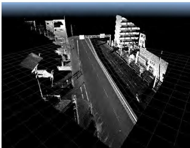
図-3 計測された三次元点群データ
