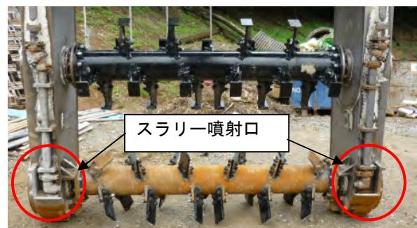
写真-7 搅拌軸およびスラリー噴射口
