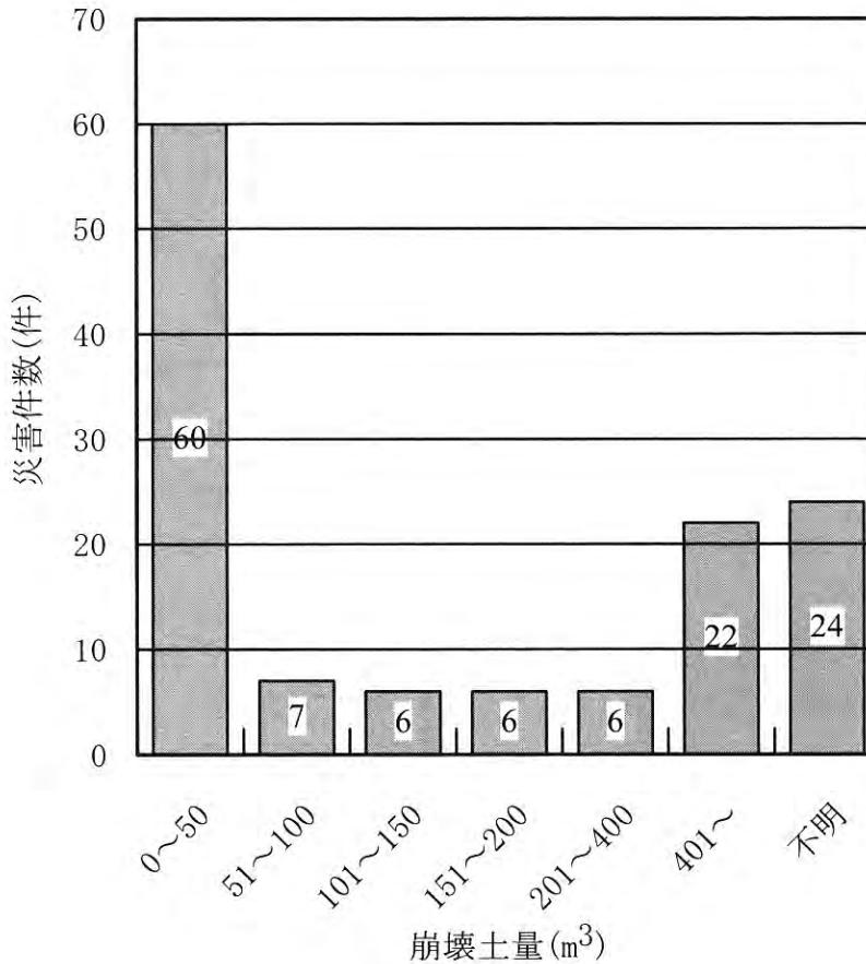
小規模な斜面の崩壊は、大規模なものと比べ瞬時に起こることが多い
