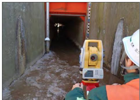
写真-7 函体内部の変位計測装置を TS で視準している状況
