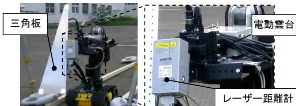
写真-4 変位計測装置
