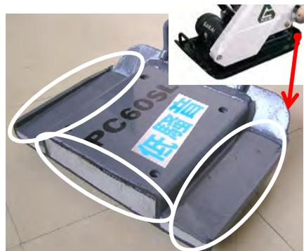
写真-2 制振材充填状況
