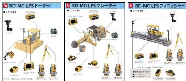
図-6 3D-MC LPS構成 (ドーザー、グレーダー、ペーパー)
