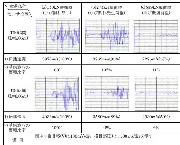
図-19 受信波形の例(透過法による)
