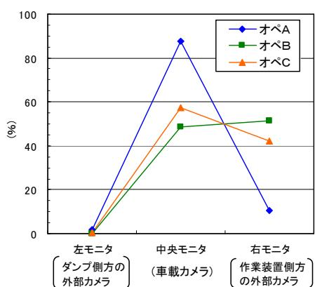
図-10 掘削積込作業試験時（掘削時）のモニタ注視率
