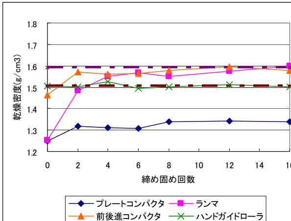
図-4 締固め回数－乾燥密度（深さ 200～300mm）
