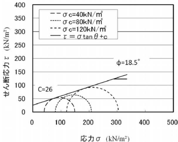
図-4 庄原市上部不搅乱飽和のモール円による破壊線
