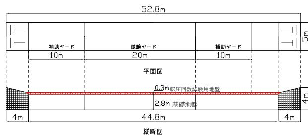
図-2. 試験ピット詳細図
