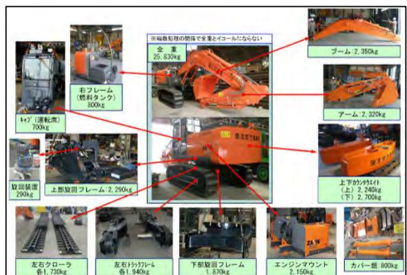
空輸対応型油圧ショベル( $1.0\text{m}^3$ 級)分割図
