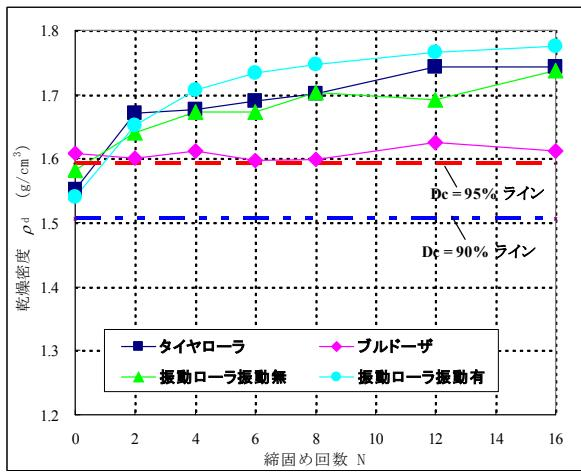
図-4. 乾燥密度—締固め回数 ( $h=0\text{-}100\text{mm}$ )
