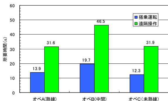
図-6 均し作業試験の平均サイクルタイム
