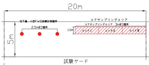
図-3. 締固め回数試験計測箇所平面図
