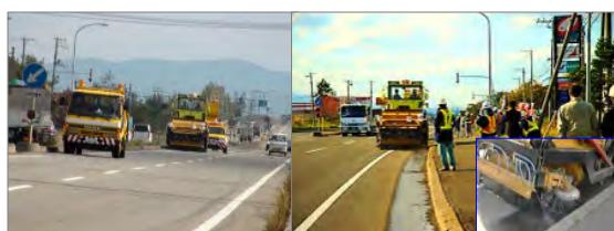
写真-4 試作機の清掃状況
