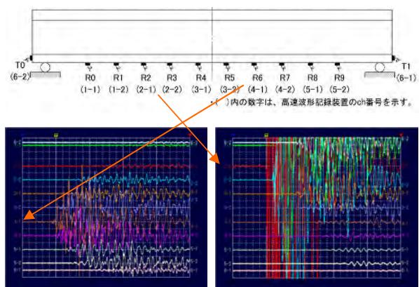
(a) 550kN 時 (b) 559kN 時 (PC 鋼材破断)
