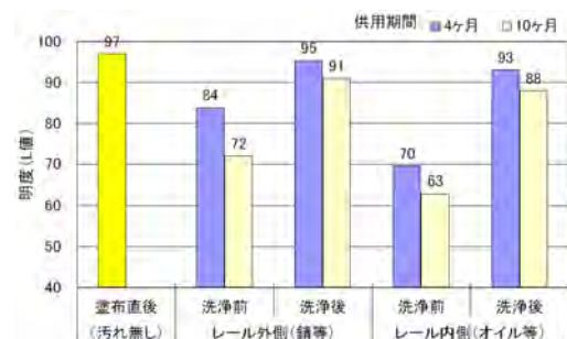
図-9 実軌道における洗浄性確認結果
