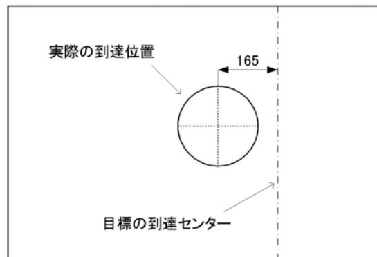
図-9 削孔精度の測定 (脆弱層 10N/mm<sup>2</sup>)
