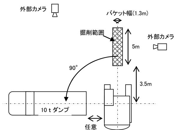
図-1 掘削積込作業試験のパターン
