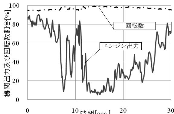
図-1 除雪作業時の負荷変動の例
