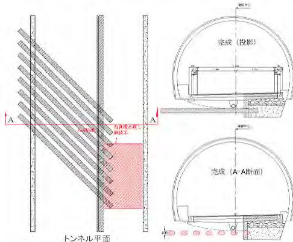
図-3 パイプフロア方式 (完成模式図)
