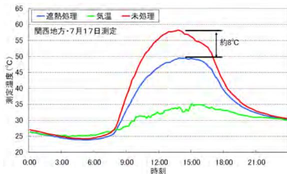
図-7 実軌道レールの温度測定例②
