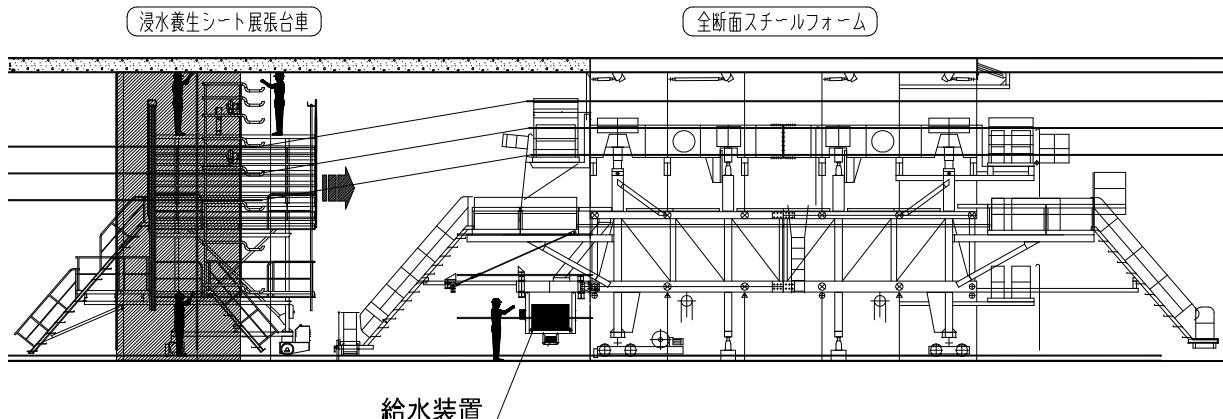
図-7 浸水養生シート展張台車配置
