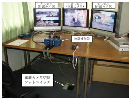
写真-2 遠隔操作室内のモニタおよび操作装置
