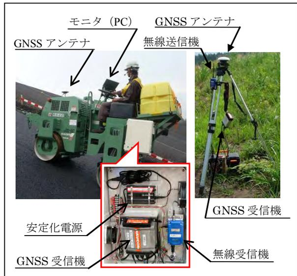
写真-1 RTK-GNSS の機器構成
