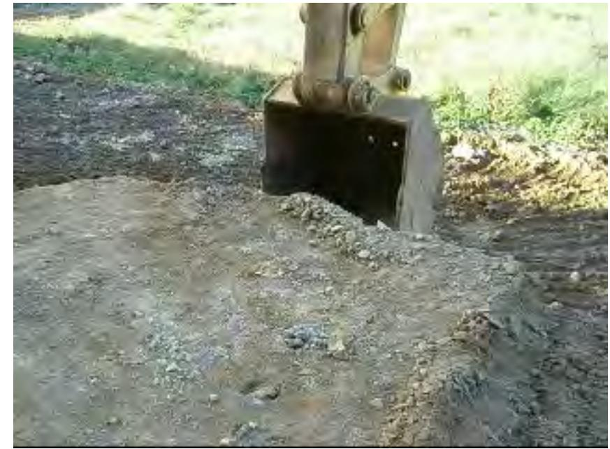
0.5mに対し0.9mの方が土塊の破壊領域が大きく、
