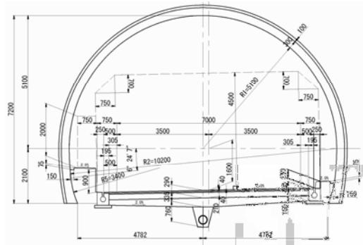
図-1 検討の対象とするトンネル断面
