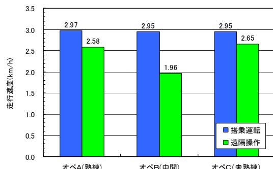
図-8 走行試験時の走行速度
