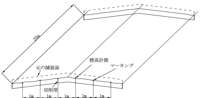
図-1 切削オーバーレイ工法の概念図
