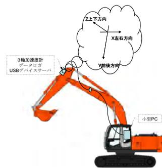
図-1 計測機器類の取り付け位置
