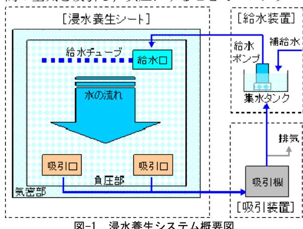
図-1 浸水養生システム概要図
