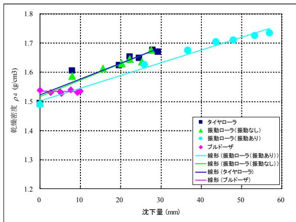
図-9. 沈下量一締固め回数
