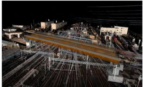
また、設計図面より作成した設計3Dモデル（施工対象物の3Dモデル）から設計形状・寸法照査を行い、工事の完成形や現況との擦り付け、施工問題点を可視化することができます。
