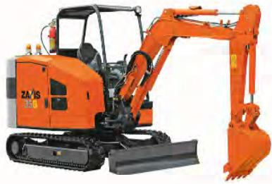
図1 バッテリショベルの外観
