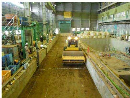
写真-4. 締固め回数試験状況
