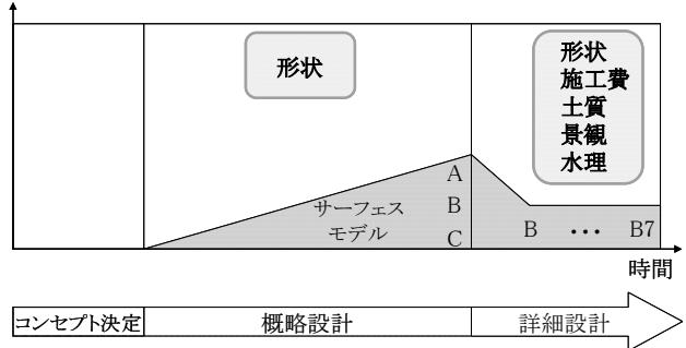
図-3 従来法による設計の流れ
