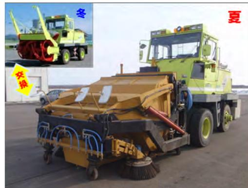
写真-1 ロータリ除雪車をベース車両にした
