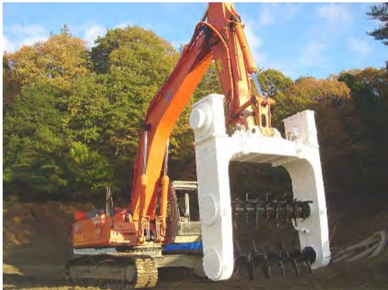
写真-8 DAM 機取付状況
