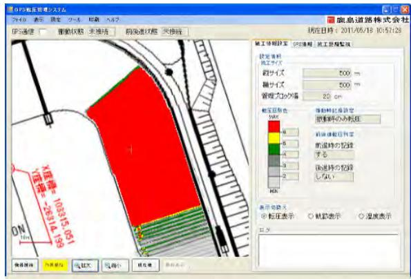
写真-3 車載 PC 転圧回数表示画面
