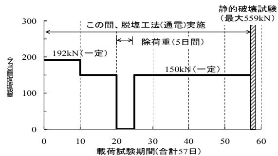
図-2 載荷試験の条件
