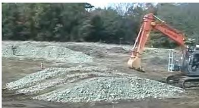
写真-2 複数回実験後の走行障害物
