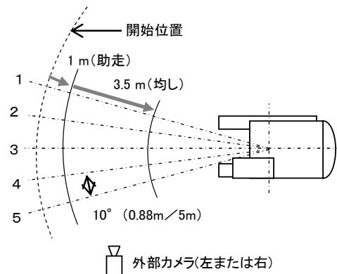
図-2 均し作業試験のパターン
