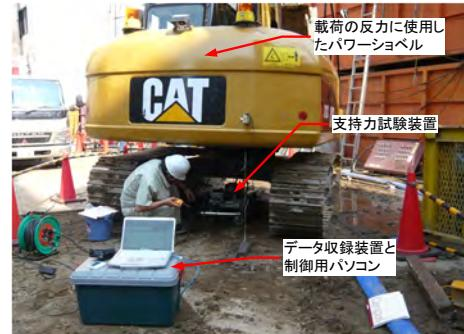
写真2 重機を反力とした支持力試験の様子
