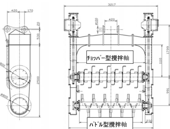
図-4 DAM 機搅拌部構造図
