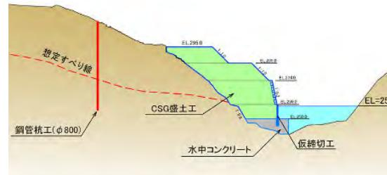
図-7 抑制工断面図
