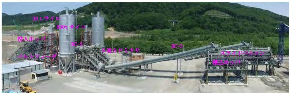
写真-5 当別ダムCSG製造設備(全景)
