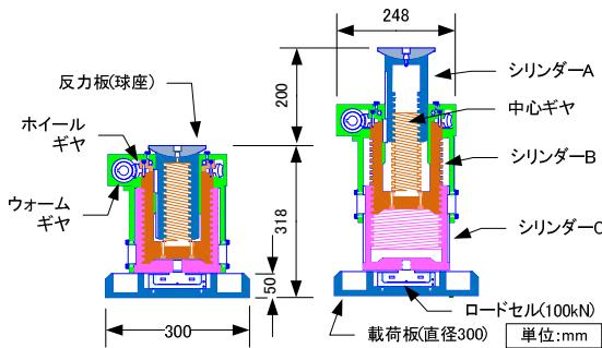
図2 載荷ジャッキの構造(左:収縮時, 右:伸張時)
