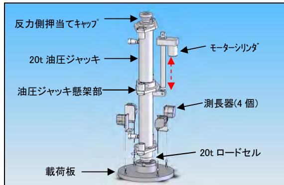
図-5 試験機油圧ジャッキ部詳細図
