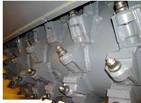
図1 岩盤切削機の切削ドラム<sup>1)</sup>
