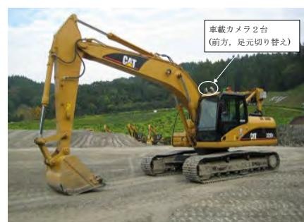
写真-1 試験に供した遠隔操作型バックホウ
