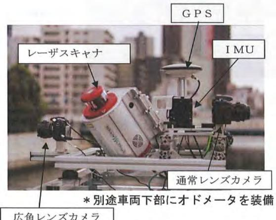
図-1 計測システムの概要
