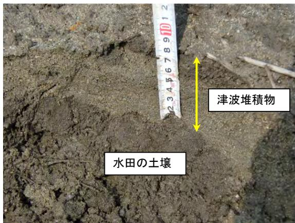
図-9 水田の土壤に堆積した津波堆積物（仙台市若林区）
