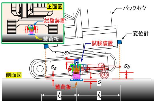
図3 機体の浮き上がり補正の方法
