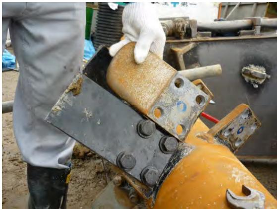
写真-9 DAM機の攪拌羽根交換状況
