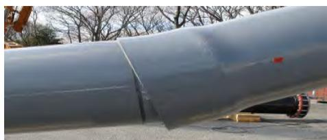
写真-6 硬質塩化ビニル管の変形状況
