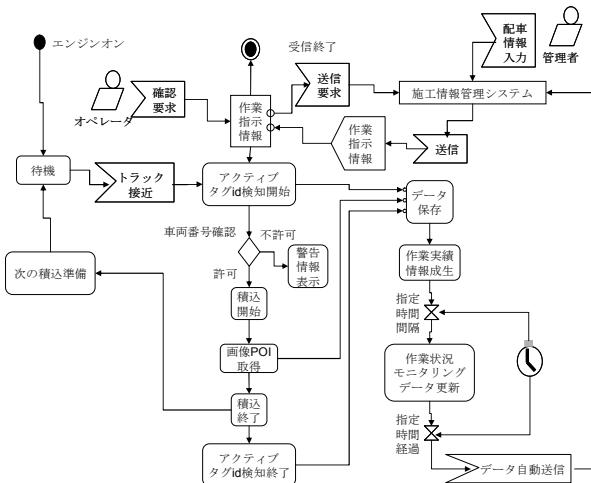
図-10 バックホウに車載するNeCo Noteの状態遷移図
