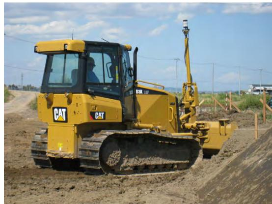
図-13 津波堆積物の剥ぎ取りに用いたブルドーザー
