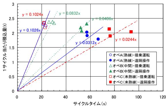
図-4 挖削積込作業試験におけるサイクルタイムと積込量
