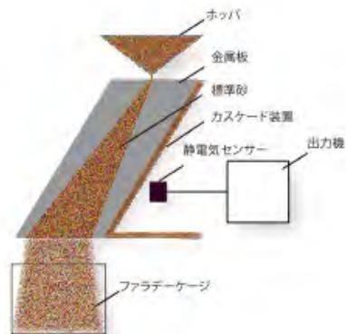
図-1 静電気帶電量計測システム
