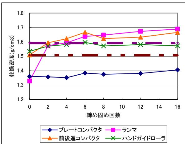
図-3 締固め回数－乾燥密度（深さ 100～200mm）
