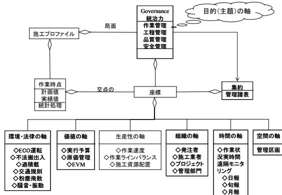
図-4 施工プロファイルの評価軸
