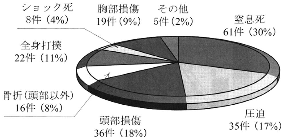
死亡原因: 約3割が窒息／約2割が圧迫 → 土砂崩壊による生き埋め
