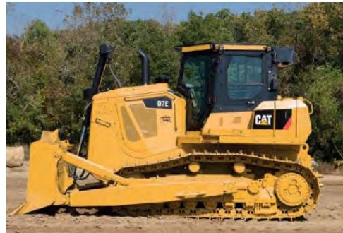
図 - 1 D7E ブルドーザ外観
