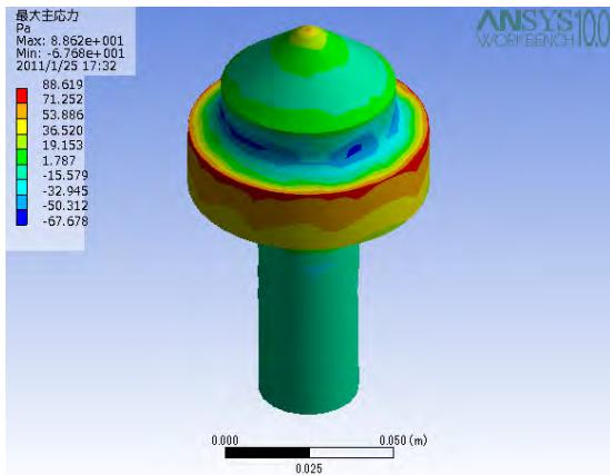
図3 最大主応力の分布状況例
