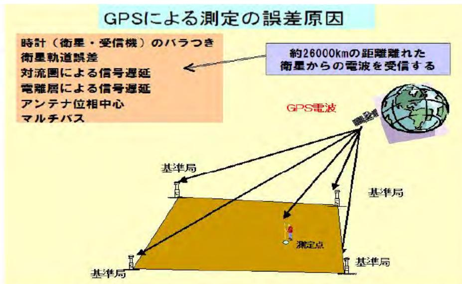
本計測システムの原理 : GPSのような26000kmではなく、数km間を伝わる電波を測れば、位置測定は高精度になる
