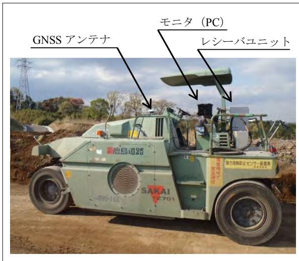
写真-2 VRS-RTK の機器構成
