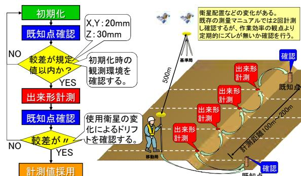
図-5 RTK-GNSSによる出来形管理の手順（案）
