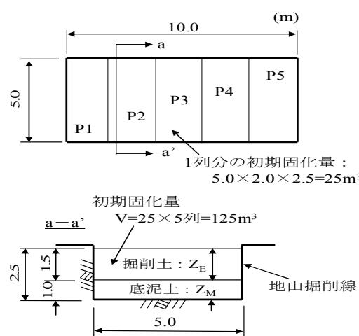
図-5 搅拌性能試験、固化ピットの形状
