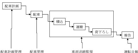
図-1 一般に考えられる車両運行管理システムが想定するワークフロー
