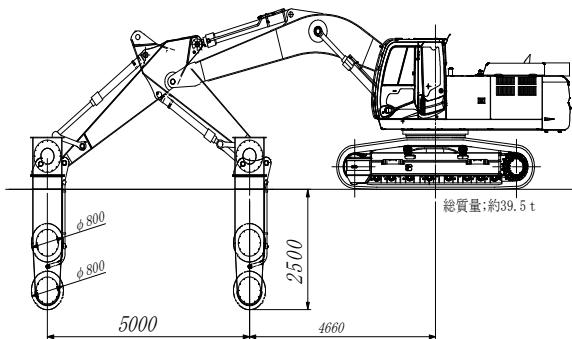
図-3 DAM 機を装着した固化改良機
