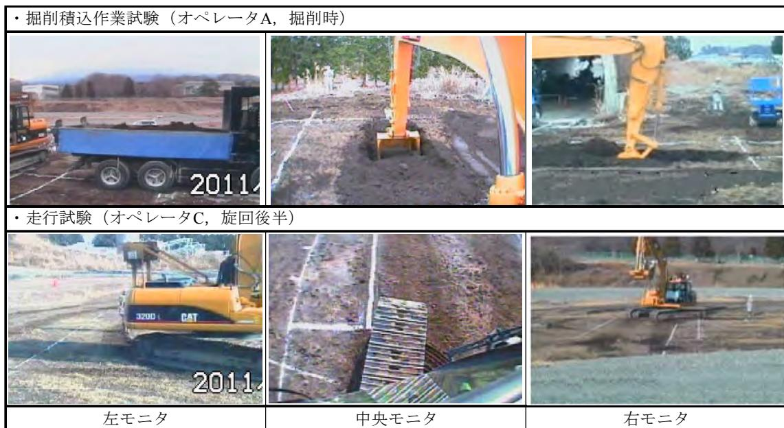
写真-3 遠隔操作時のモニタ画面の例
