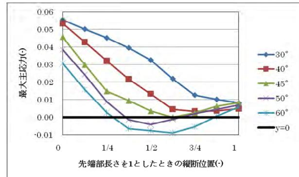
図5 ビット先端部最大主応力発生状況
