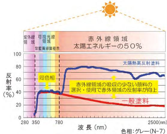
図-1 遮熱塗料の反射率の一例<sup>2)</sup>
