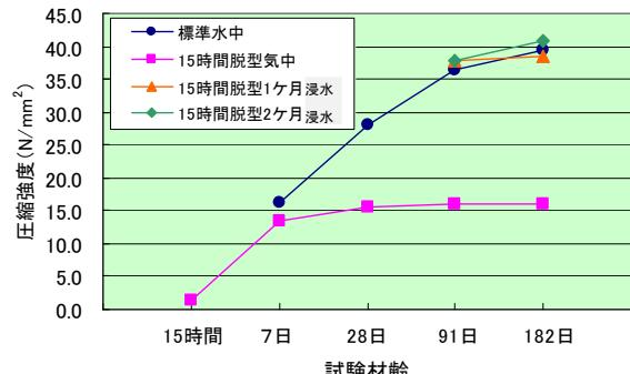
図-5 材齢と圧縮強度(円柱供試体)
