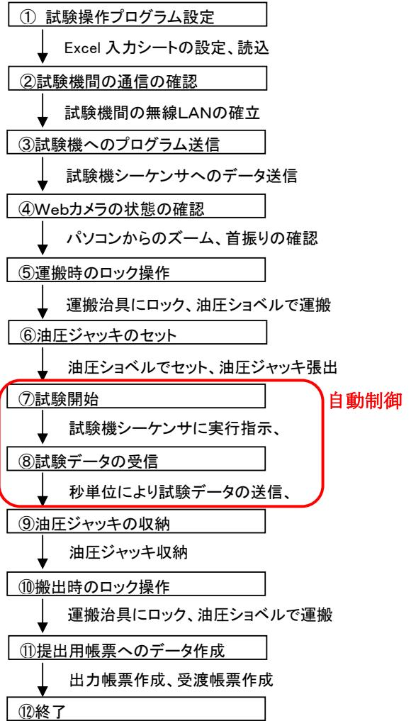
図-8 操作室側パソコン指示フロー図
