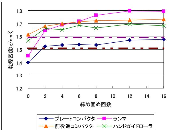
図-2 締固め回数－乾燥密度（深さ 0～100mm）
