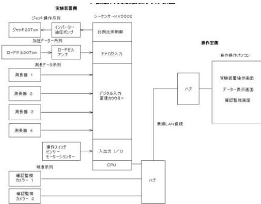
図-7 平板載荷試験機制御システム図
