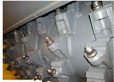
図1 岩盤切削機の切削ドラム<sup>1)</sup>
