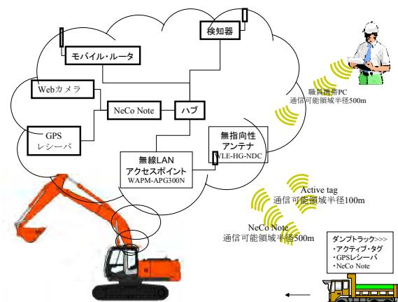
図9 基地局の構成、並びにバックホウとダンプトラック間のデータ交換のイメージ
