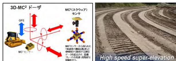
図-5 3D-MC<sup>2</sup> (スクウェア) ドーザー
