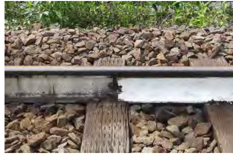
写真-8 洗浄性確認試験結果(オイル汚れ)
