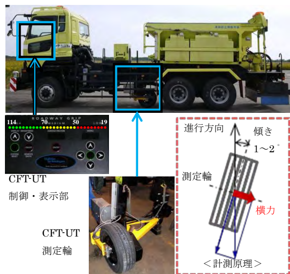
図-1 CFT-UTとCFT-UTを搭載した凍結防止剤散布車および計測原理
