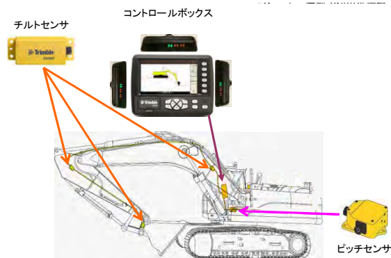
図-5 二次元 MG の機器構成
