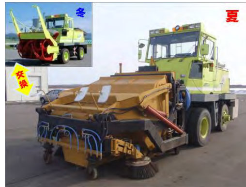
写真-1 ロータリ除雪車をベース車両にしたアタッチメント式路面清掃装置（試作機）
