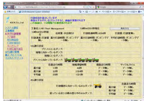
図 6 運行状況実時間遠隔監視画面例
