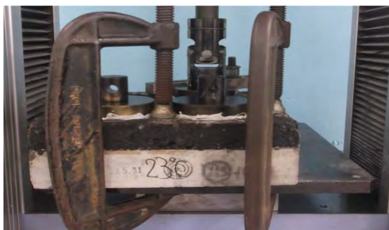
写真-2 荷重制御可能な万能試験機(舗装後の接着性)
