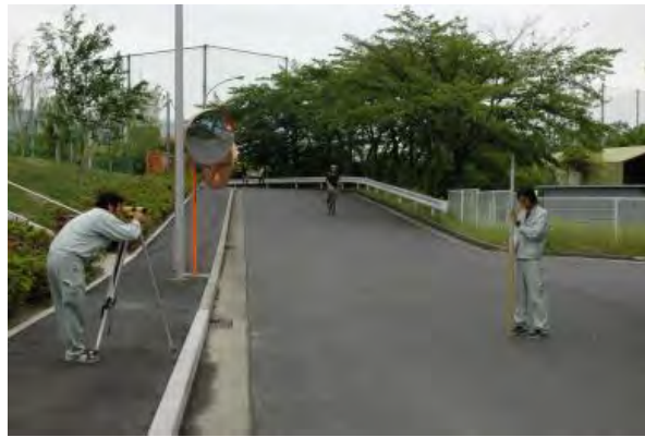
写真-9 Auto Levelによる1m毎の測点の標高計測
