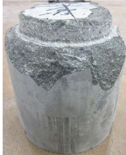
写真-2 掘削終了時の供試体 (刃 D, 切込幅 20mm, 垂直力 12.5kN, 1 回目)
