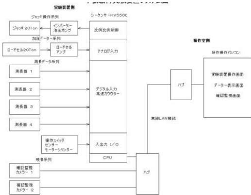
図-7 平板載荷試験機制御システム図
