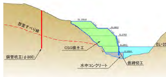
図-7 抑制工断面図
