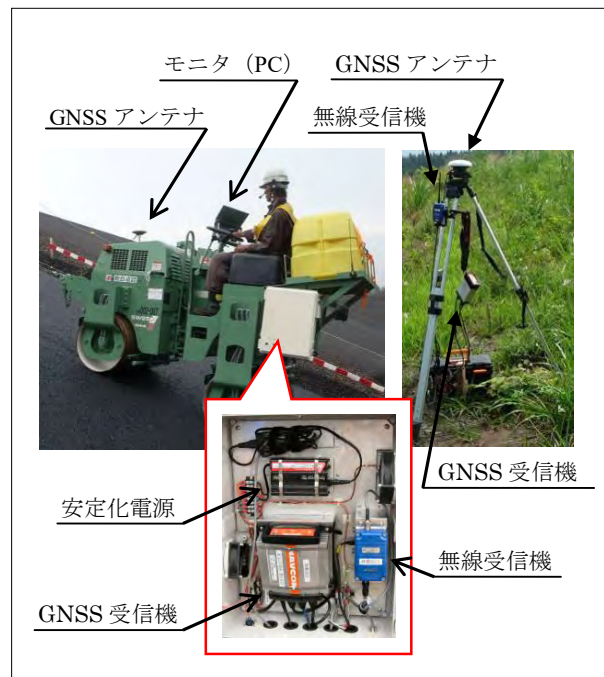
写真-1 RTK-GNSS の機器構成 移動局（左上）、基地局（右上）
