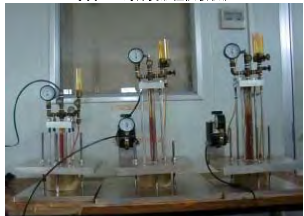
写真-6 防水性試験Ⅱ装置(舗装後の防水性)
