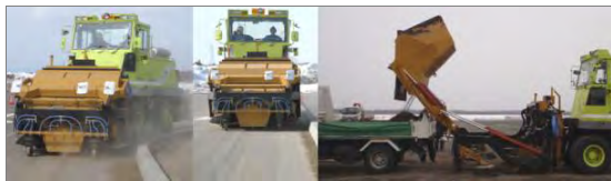
写真-2 性能試験状況 左：道路線形追従走行試験 中：清掃能力試験 右：ダンプトラックへの積み込み試験
