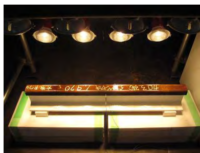
写真-6 室内照射試験一例
