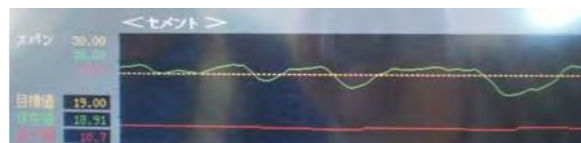
写真-3 セメント供給量監視グラフ(不安定時)
