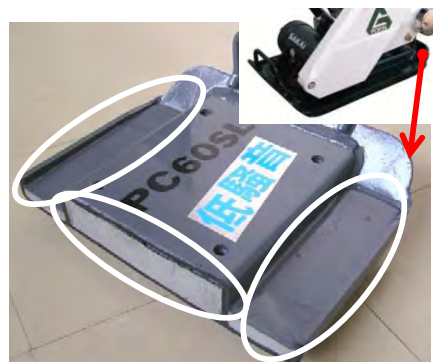
写真-2 制振材充填状況
