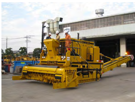
写真-1 地盤整正機全景
