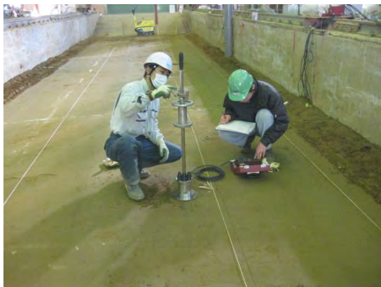
写真-6. 小型 FWD 試験状況
