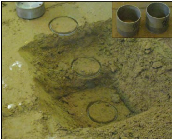
写真-5. コアサンプリング状況
