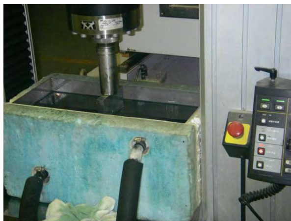
写真-7 供試体曲げ試験状況
