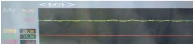
写真-4 セメント供給量監視グラフ（安定時）
