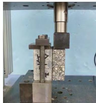
写真-7 変位制御可能な万能試験機(舗装後のせん断抵抗性)
