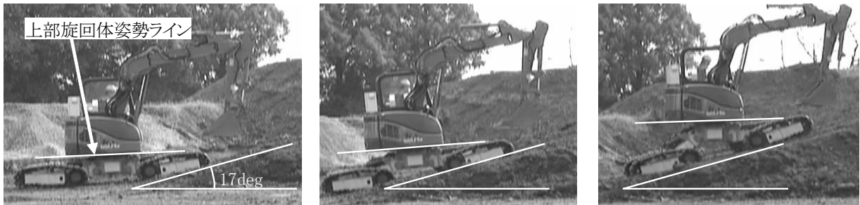
写真-3 姿勢水平制御実験
