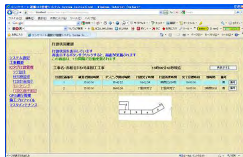
図-8 作業状況実時間遠隔モニタリングのコンクリート打設速度管理PC画面例
