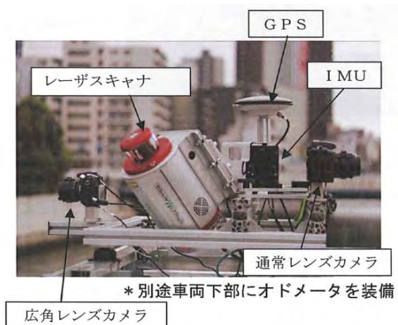
図-1 計測システムの概要
