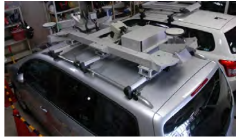
写真-2 MMS の車外搭載機器の上方からの外観
