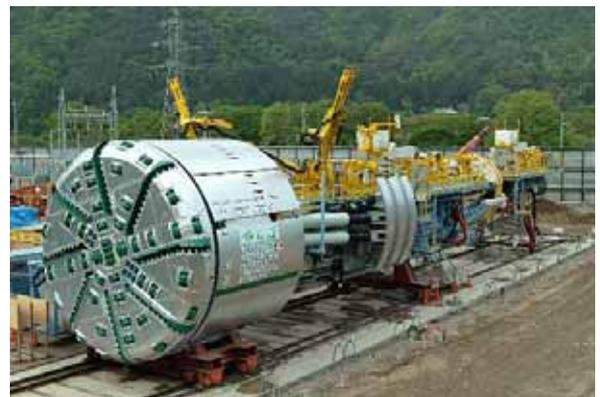
写真-1 改良オープン型TBM
