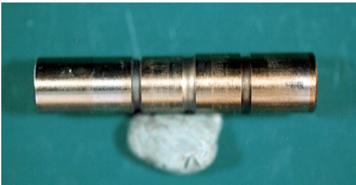
付図 7 サーボバルブピストンのラッカーの例
