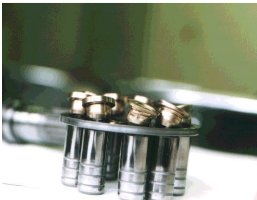
付図 5 ピストンシューの異常摩耗の例 (判定は付表による)
