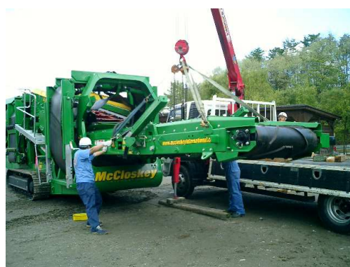
写真 4-2 自走式ふるい機輸送用分解 例
