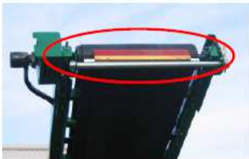
写真 4-6 コンベヤベルト・スクレーパ作動確認作業例
