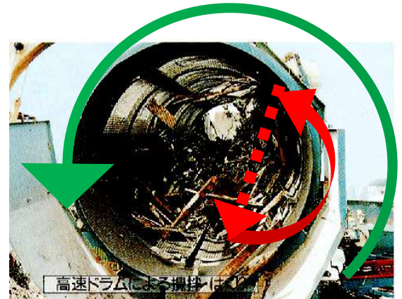
写真 3-3 トロンメルドラム内部
