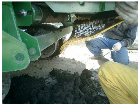
写真 4-6 コンベヤベルト・スクレーパ作動確認作業例
