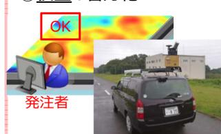
MMS等の移動体計測技術を導入、机上検査化して検査書類を半減
