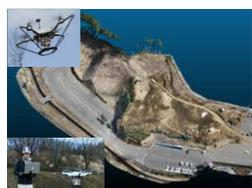
ドローン等による写真測量等により、人の立ち入れない危険な急傾斜も短時間で面的（高密度）な3次元測量を実施。
