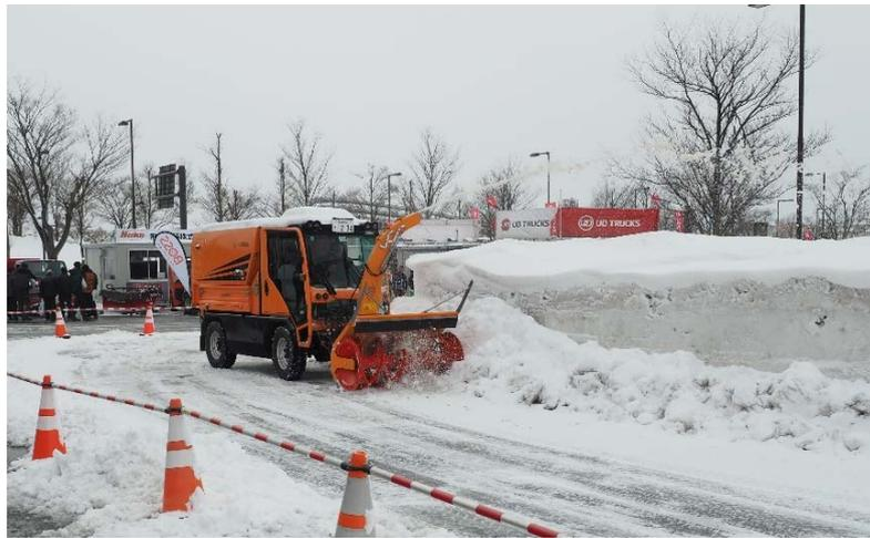
写真 38 矢野口自工(株)ロータリ除雪車 LADOG LN
