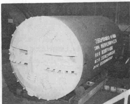
写真—10 日立建機クラッシュャ付泥水加压シールド掘進機
