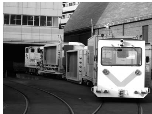
写真二 トンネル部石綿除去作業専用台車
