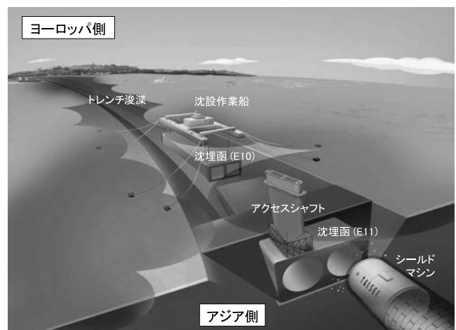
図一12 アジア側沈埋・シールドトンネル接続部付近模式図
