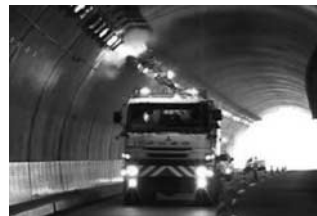
図-2 高速清掃 (50km/h) のテスト状況
