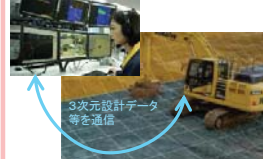
③ICT建設機械による施工
