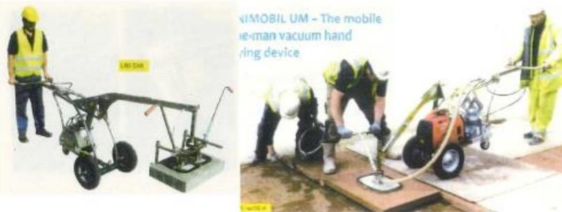
4. ブロック等運搬用の簡易型運搬機(外国製)の導入
