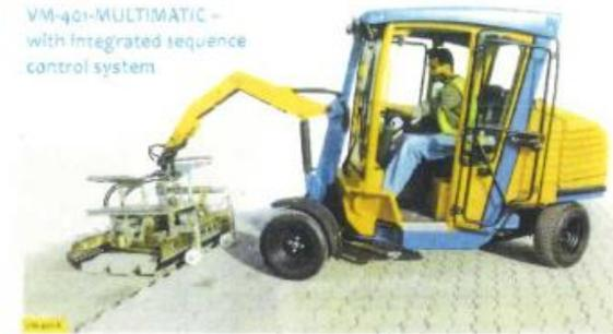
3. コンクリート二次製品の運搬・据付け用に、バキューム動力を利用した小型運搬機(外国製)を導入
