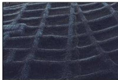
法面に対して鉛直方向の離れを厚さとして算出
