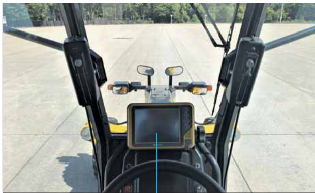
コントロールボックス
