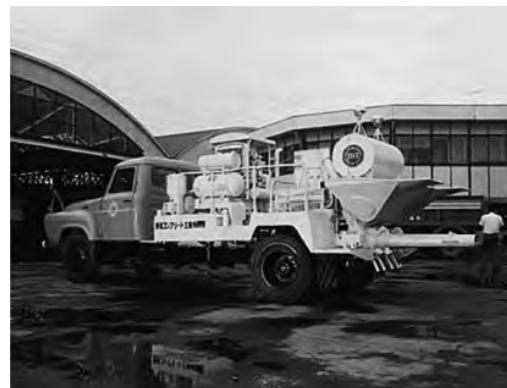
写真-12 トラック搭載式コンクリートポンプ
