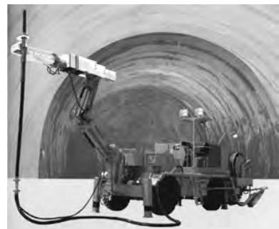
写真-20 コンプレッサ搭載型吹付け機
