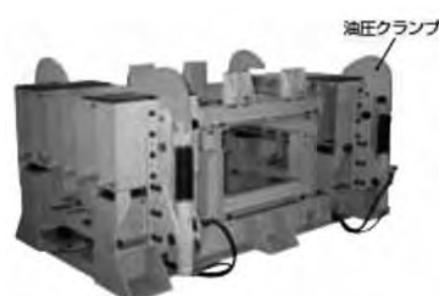
写真-23 大型セグメント製造用テーブルバイブルータ
