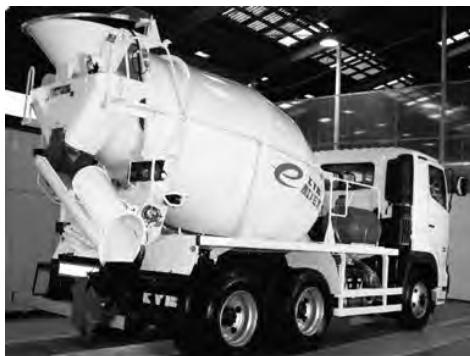
写真-11 電子制御式トラックミキサ
