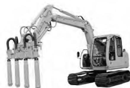
写真-24 ダム用バイブルータ“バイバック”
