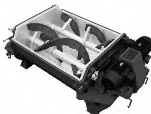
写真-7 水平2軸形強制練りミキサ
