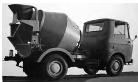
写真-9 傾胴型 トラックミキサ
