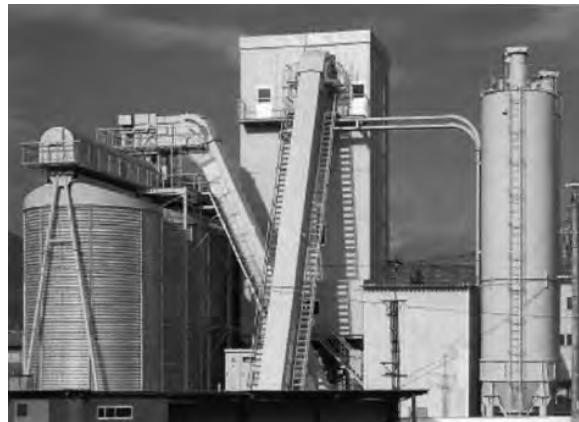
写真-4 骨材輸送装置（急傾斜式）
