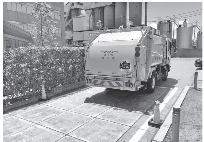
写真一3 車両走行による強度的耐久性確認
