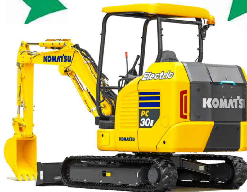
《バッテリー駆動式ミニショベル PC30E-5》
