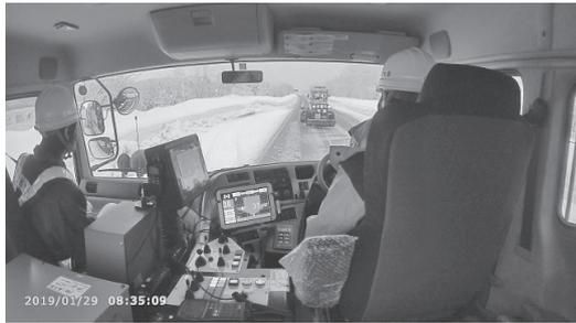
写真-12 ガイダンスを使用している除雪作業
