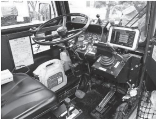
写真—10 歩道除雪車用ガイダンス装置
