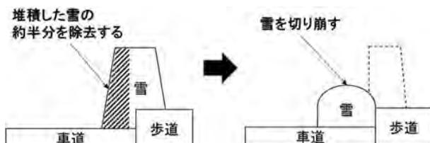
図-1 拡幅作業のイメージ
