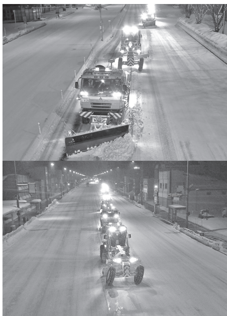
写真—11 国道除雪風景 [除雪トラック (トラックグレーダ装置付), 除雪グレーダ]
