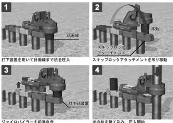
図-6 スキップロック工法の概要
