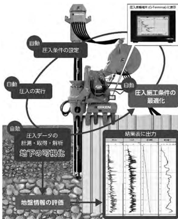
図一7 PPTS 自動運転システムの概要
