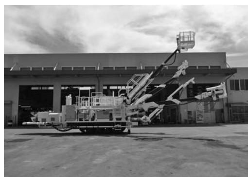
写真-1 小断面クローラ式エレクター付吹付け機(第3次排出ガス対応型)
