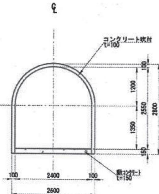
図一 3 トンネル断面図（CH級岩盤）
