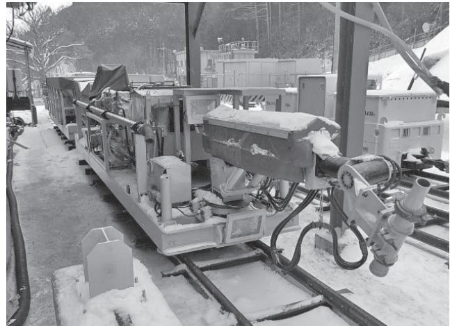
写真-10 吹付ロボット台車
