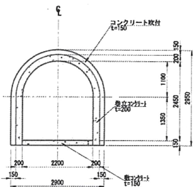
図一 2 トンネル断面図（坑口）
