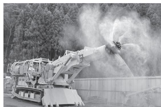
図-6 自由断面掘削機 (330 kW級)
