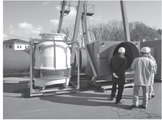
写真-15 トンネルクーラー (左:クーリングタワー, 右:ラジエーター)
