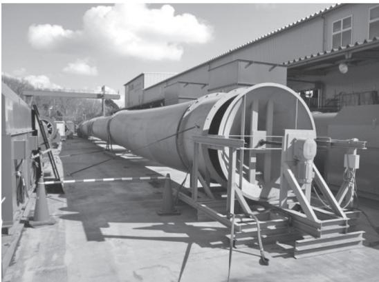
写真-14 3,000 m<sup>3</sup>/分 (160 kW × 4 連) ファン性能試験
