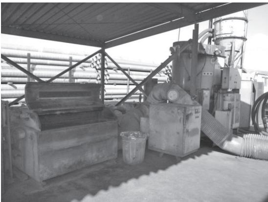
写真-12 集塵機フィルター洗浄機
