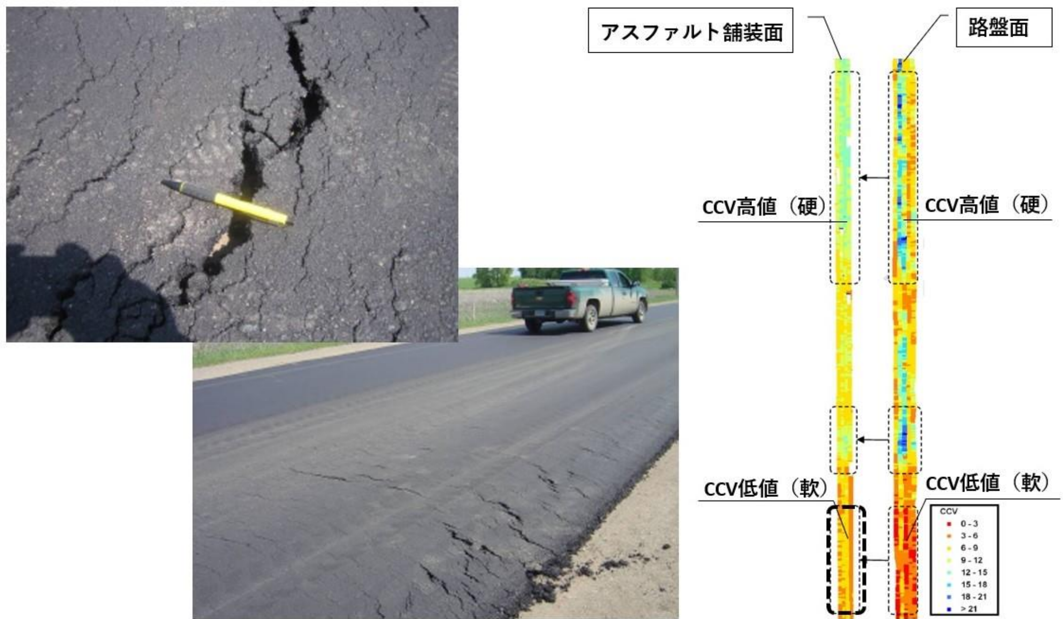
図 CCVによる舗装路面の不良個所特定
