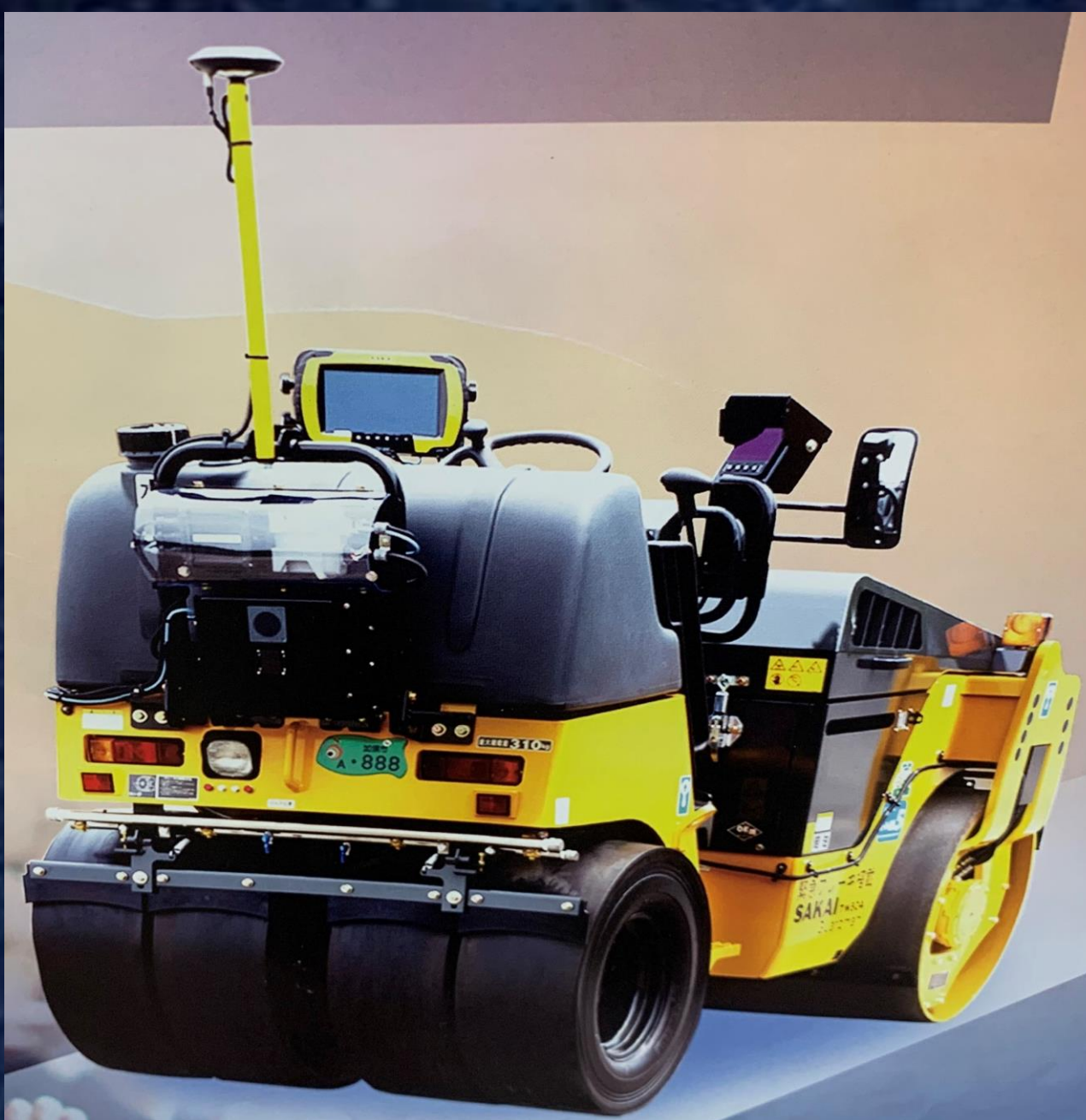
図 転圧管理システム付き4tコンバインドローラ(TW504系)
