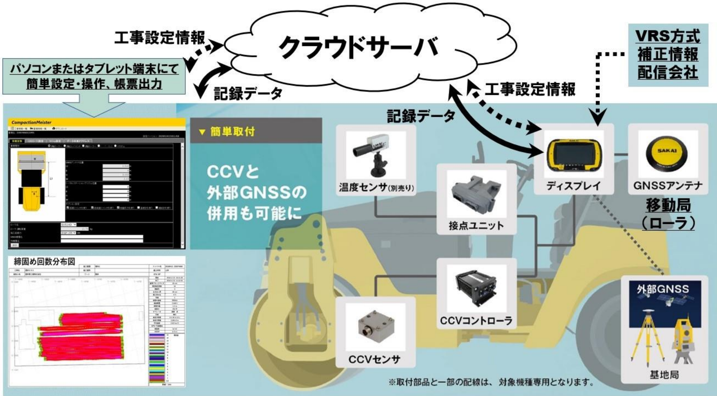
図 転圧管理システムの概要図
