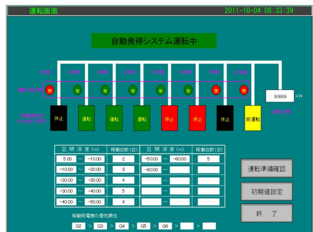
図-3 発電機自動発停装置表示例
