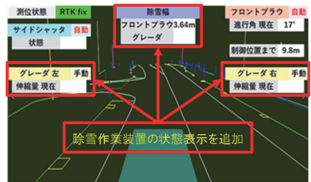
図-6 自動操作制御装置の表示画面例
