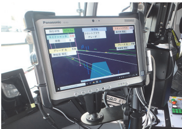
写真-2 自動操作制御装置
