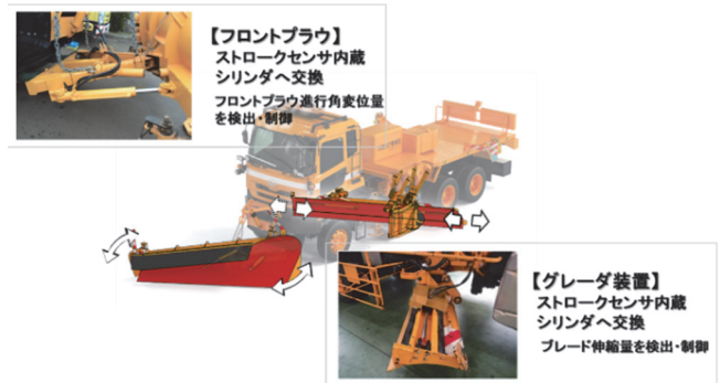
図-5 除雪トラック試験機改良箇所
