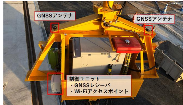
写真-5 GNSS 受信装置（フックブロック）
