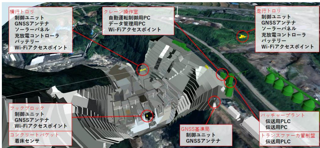
図-3 システムを構成する機器及び設置個所
