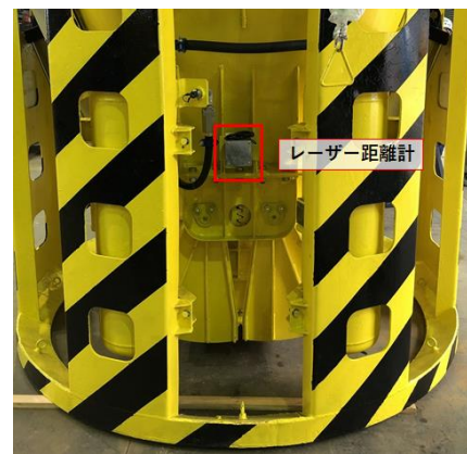
写真-6 コンクリートバケット
