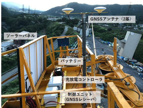
写真-4 GNSS 受信装置（走行トロリ）
