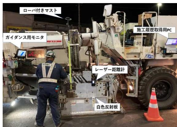
写真-1 GNSS式MGと施工履歴システムの設置状況
