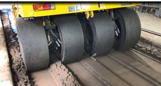
写真-4 TZ-12t (条件 ; w2) 【走破性判定 : △】
