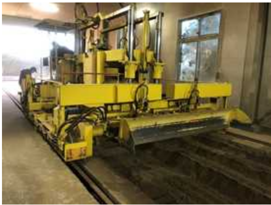
写真-1 敷き均し用ブレード付スタビライザ
