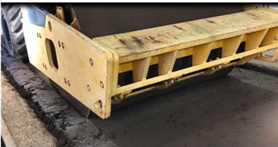
写真-3 SV-20t (条件 ; w3) 【走破性判定 : ×】
