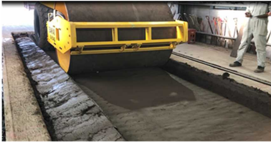
写真-2 SV-12t (条件 ; w3) 【走破性判定 : ○】
