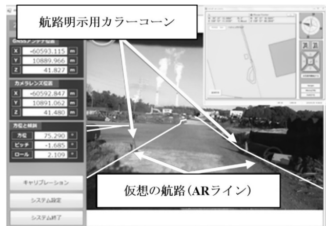
図-5 ARライン描画状況 (RTK-GNSS方位計使用)
