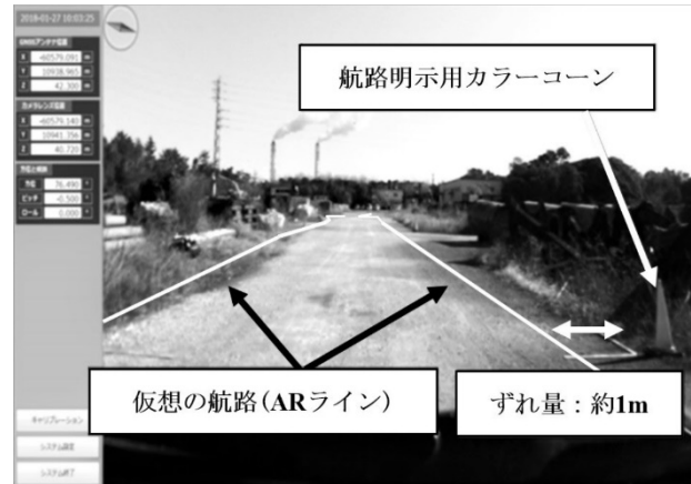
図-4 ARライン描画状況 (D-GNSS方位計使用)
