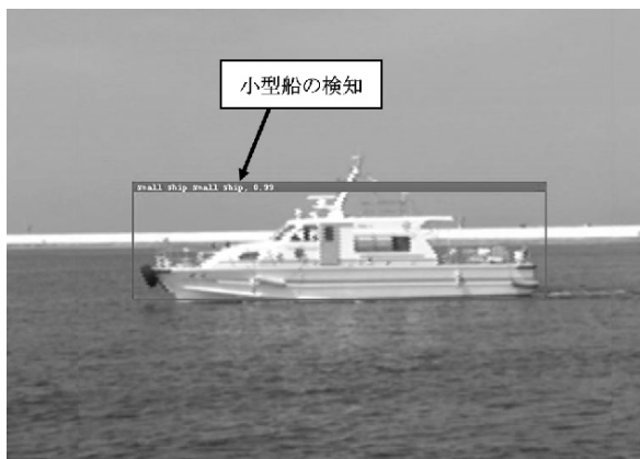
図-12 小型船の検知状況
