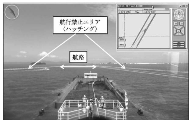
図-10 システム画面(土運船運搬時)
