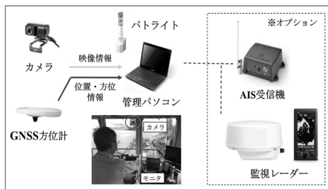
図-2 船舶用機器構成図
